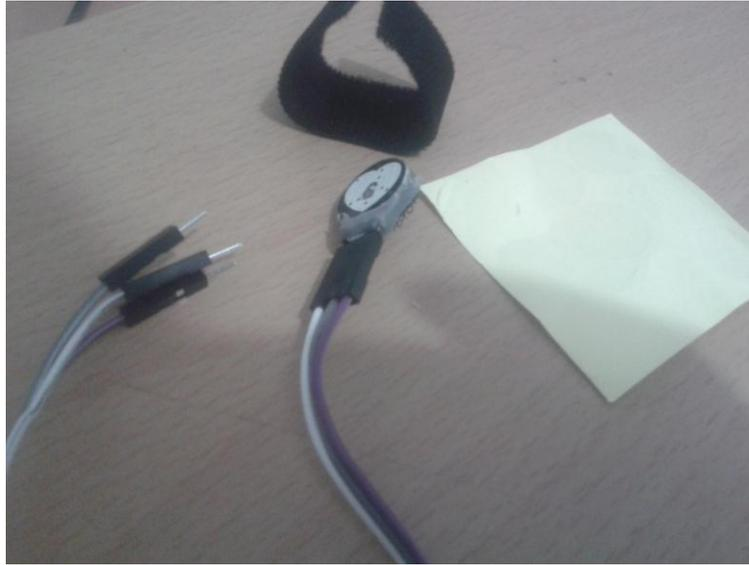
Figura 4.2 Sensor de pulsos con accesorios
