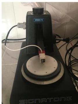
Figura 19. Equipo de medición de 4 puntas Signatone.
