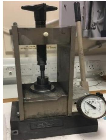
**Figura 10. Imágenes de los equipos de prensado utilizados para la compactación de las pastillas.**
