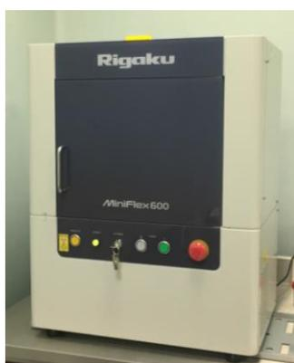
Figura 11. Equipo de DRX RIGAKU MiniFlex 600
