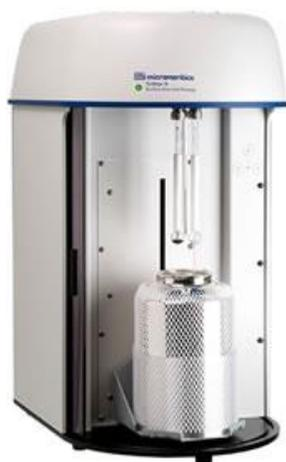
**Figura 15. Equipo Micrometrics Tristar II 3020 utilizado para el análisis BET.**
