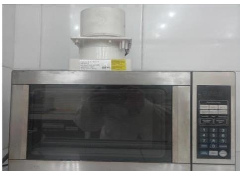
Figura 9. Horno de microondas modificado LG LMS1190ST.
