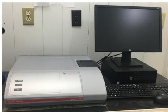
**Figura 14. Equipo de dispersión de luz dinámica (DLS) Litesizer 500**
