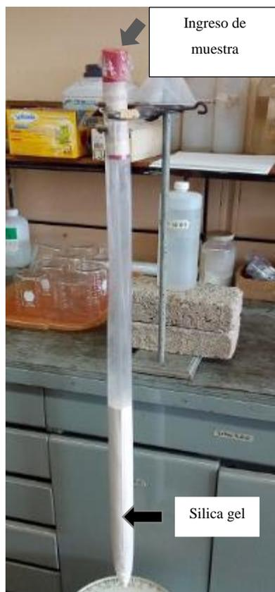
*Figura II.11. Columna de cromatografía empacada con silica gel.*
