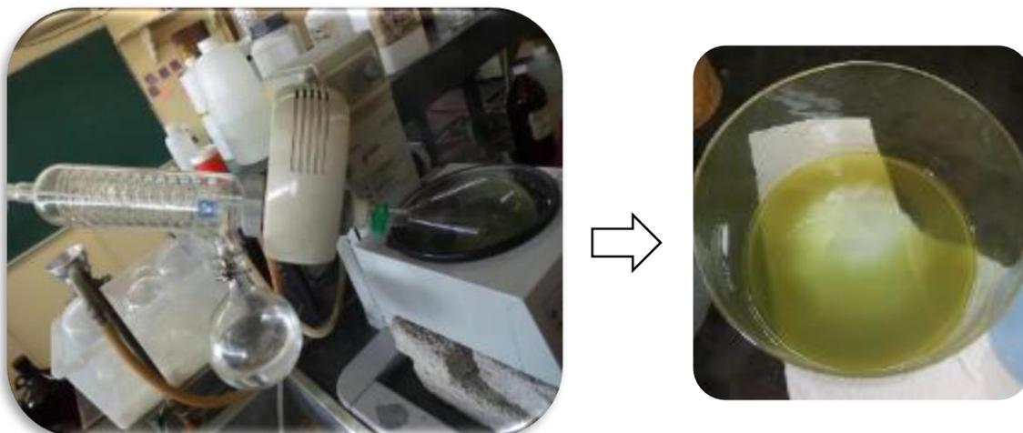
*Figura II.5. Rotavapor utilizado para la concentración de los extractos.*
