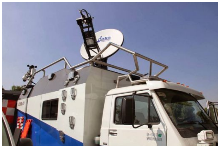
Figura 1-4 Estación terrena móvil [23]
