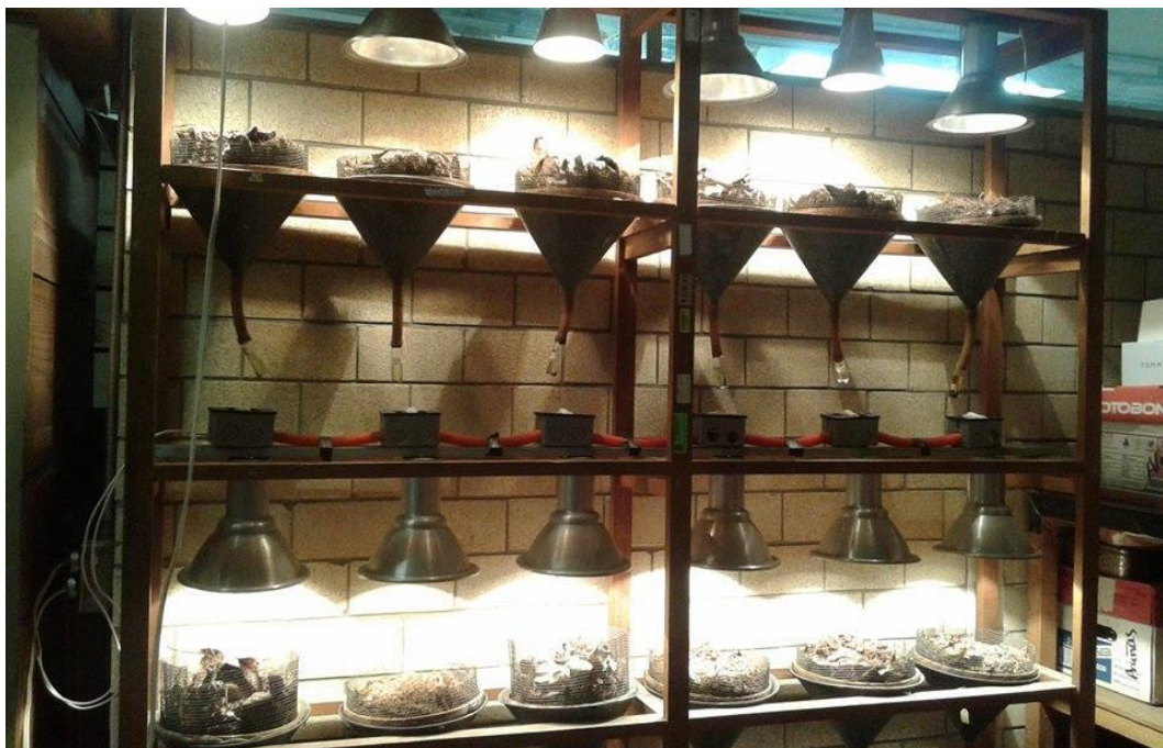
Figura 10. Procesamiento de la hojarasca y suelo en los embudos de Berlese-Tullgren.
