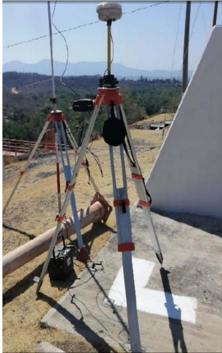
**Figura 2.1** Fotogrametría terrestre, origen horizontal y vertical del levantamiento. (Argeomática, 2020).
