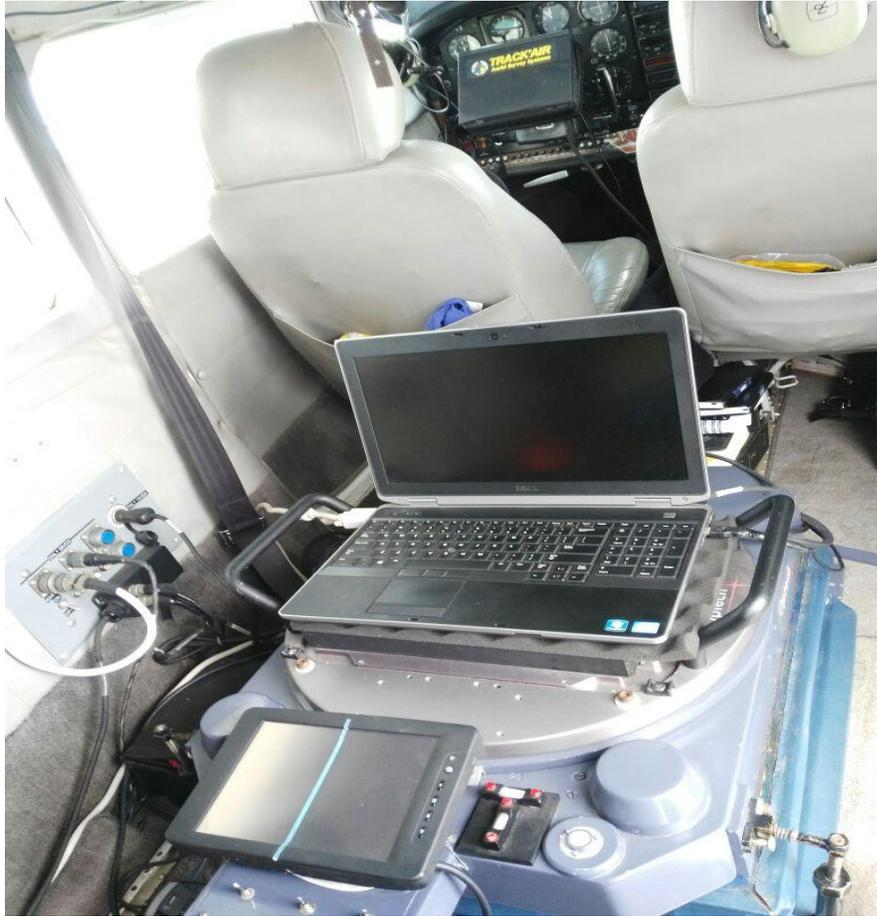
**Figura 2.3** Cámara aérea marca Optech CM-10000 para la adquisición de imágenes digitales (Argeomática, 2020).
