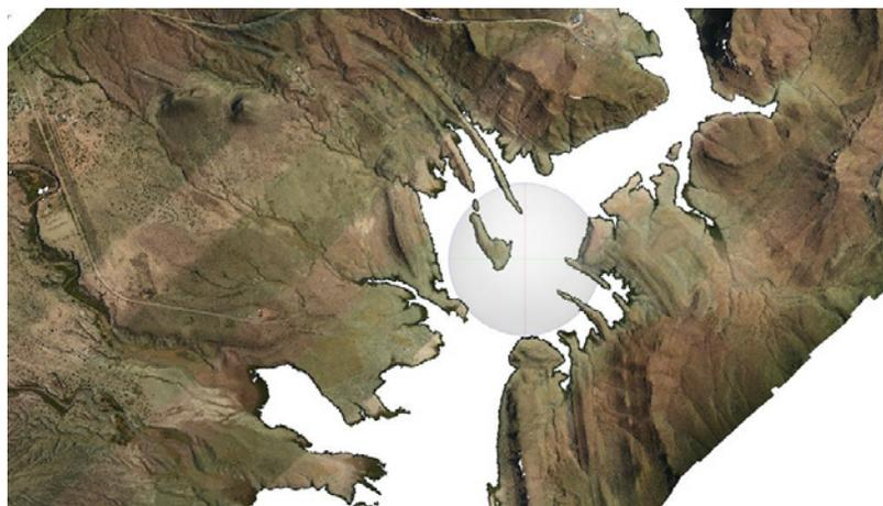
**Figura 4.2** Nube de puntos densa en Metashape. La escala a la que se capturó esta imagen proyecta todos los puntos como si se tratara de la ortofotografía general.
