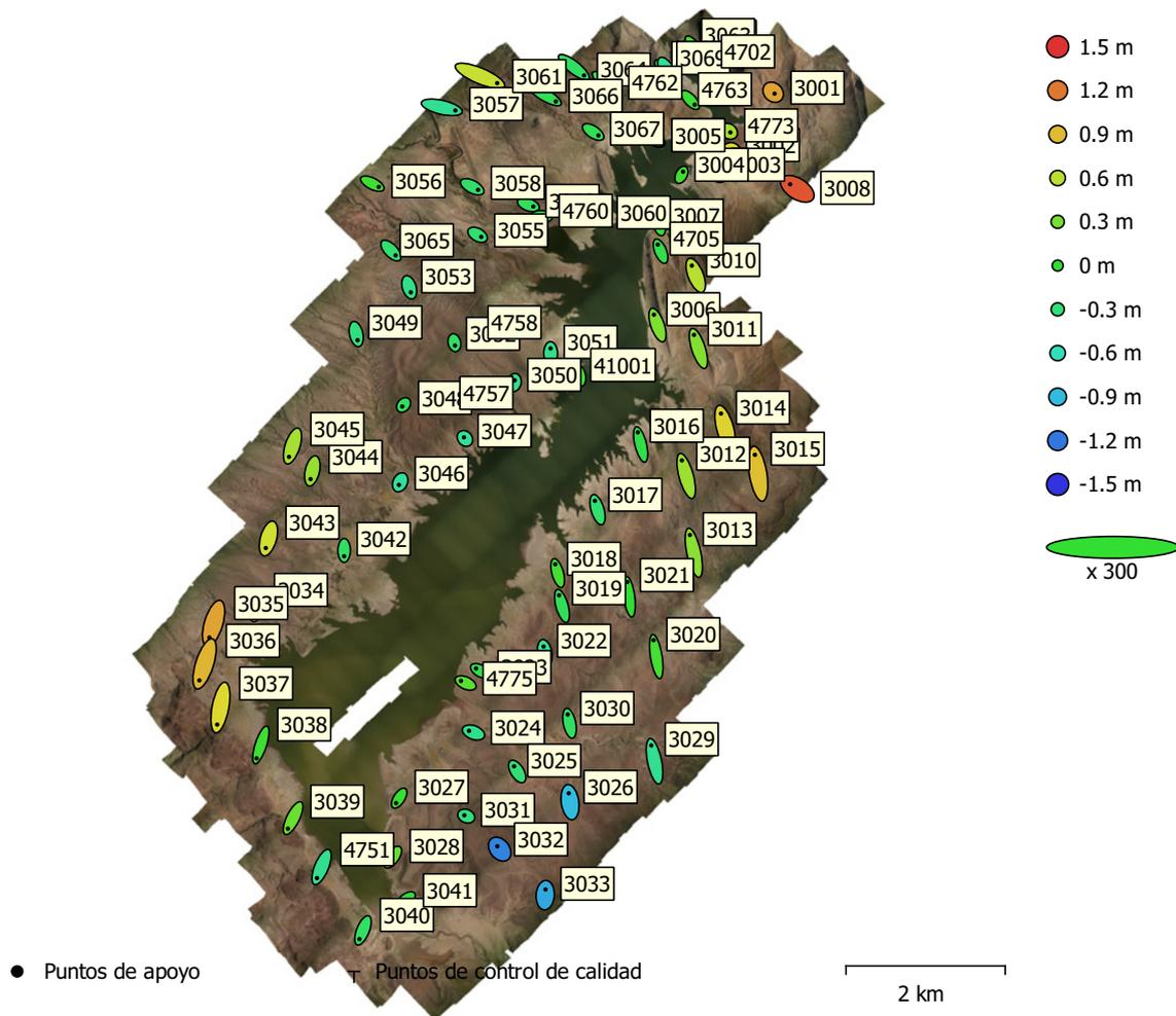
Fig. 5. Posiciones de puntos de apoyo y estimaciones de errores.
