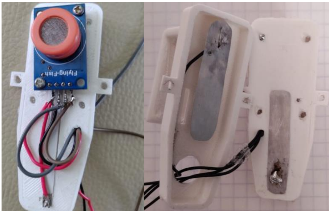
Figura 58. Estructura interna del alcoholímetro.
