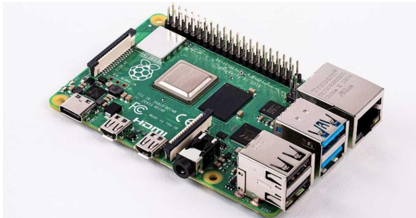
Figura 25. Raspberry Pi 4 modelo B.
