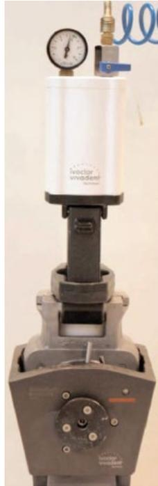
FIGURA 6. SISTEMA DE INYECCIÓN IVOCAP POR IVOCLAR VIVADENT
