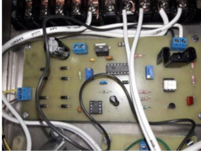
FIGURA 65. PLACA FINAL CONTROL DE ÁNGULO DE FASE
