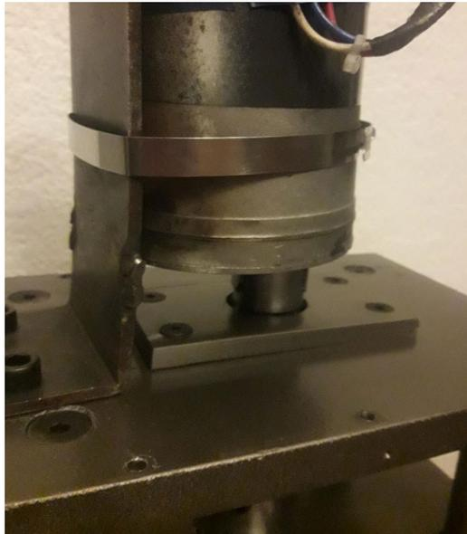
FIGURA 71. MONTAJE DE ELEMENTO DE SUJECIÓN PARA RODAMIENTO
