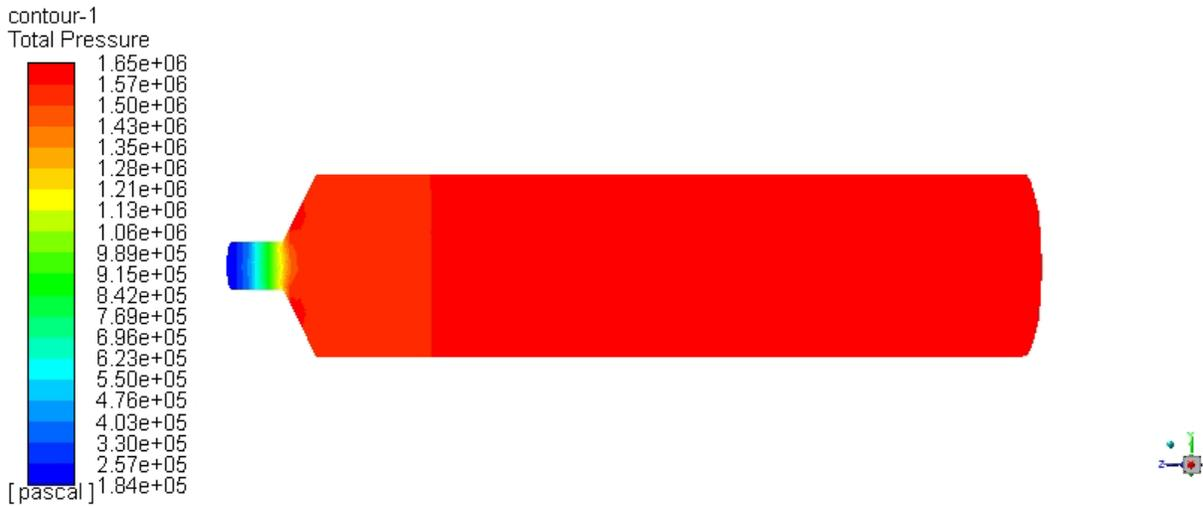
FIGURA 25. VISTA LATERAL DE RANGO DE PRESIÓN SOBRE CARTUCHO DE COPOLIMERO RANDOM DE POLIPROPILENO
