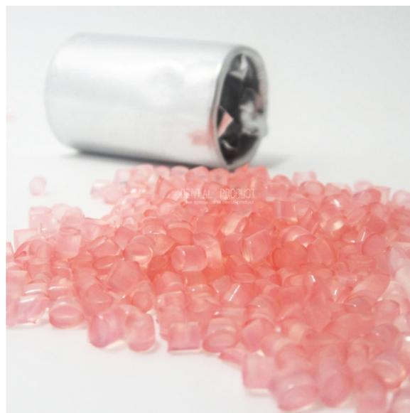
FIGURA 20. ASPECTO FÍSICO DE MATERIAL TERMOPLÁSTICO
