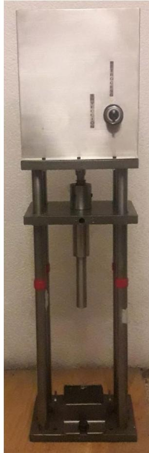
FIGURA 74. MONTAJE FINAL DE SISTEMA DE INYECCIÓN
