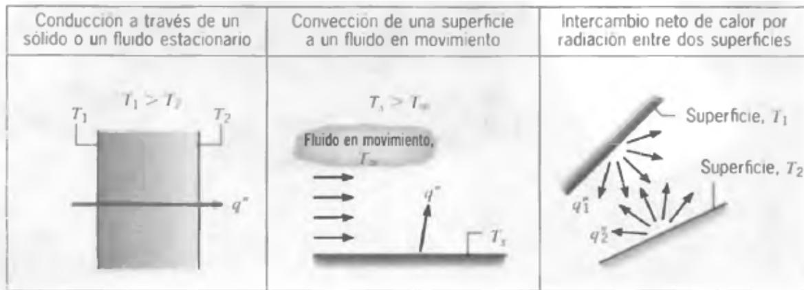
FIGURA 17. MODOS DE TRANFERENCIA DE CALOR: CONDUCCIÓN, CONVECCIÓN Y RADIACIÓN.
