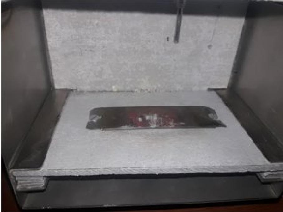
FIGURA 81. MONTAJE DE RESISTENCIA ELÉCTRICA EN SISTEMA DE PRECALENTADO PARA LA MUFLA
