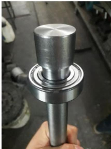
FIGURA 61. ACOPLAMIENTO MOTOR-SISTEMA DE INYECCIÓN Y RODAMIENTO
