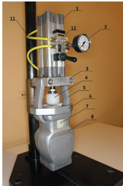
FIGURA 7.LA UNIDAD DE INYECCIÓN DEL SISTEMA IMPROVISADO
