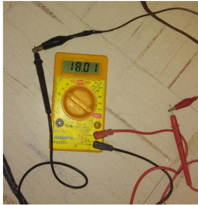
Figura. 45 Voltaje de la fuente
