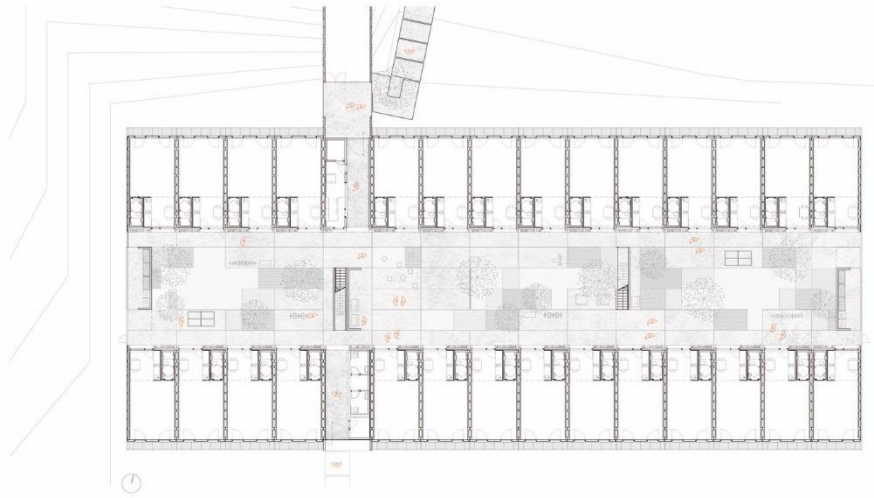
Ilustración 52 Planta tipo del proyecto, se muestra la modulación de este y su patio central.
