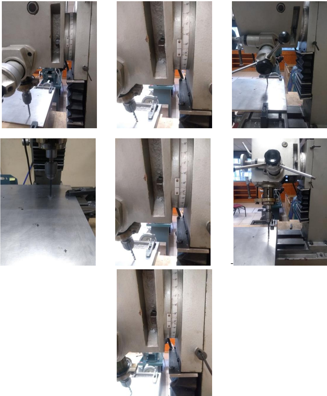
FIGURA 100.-PERFORACIÓN DE PLACA PARA ESCENARIO DE PRUEBAS
