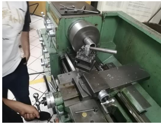
FIGURA 96.-CAREADO Y REDONDEO DE TUBOS PARA ESLABONES
