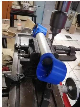
FIGURA 97.-PERFORACIÓN Y GENERACIÓN DE CUERDA DE TUBOS
