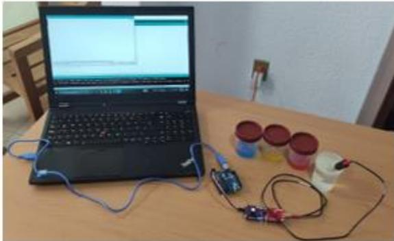
(a) Calibración del sensor de pH
