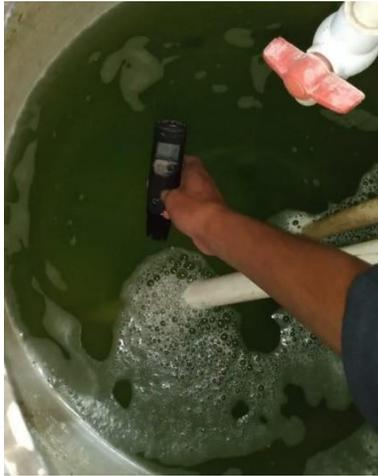
*Figura 5 Medición de la CE de la solución nutritiva para riego.*
