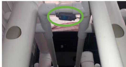
(c) Sensor de temperatura y humedad
