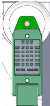
Figura 71 Acercamiento al sensor de humedad y temperatura dentro de una carcasa
