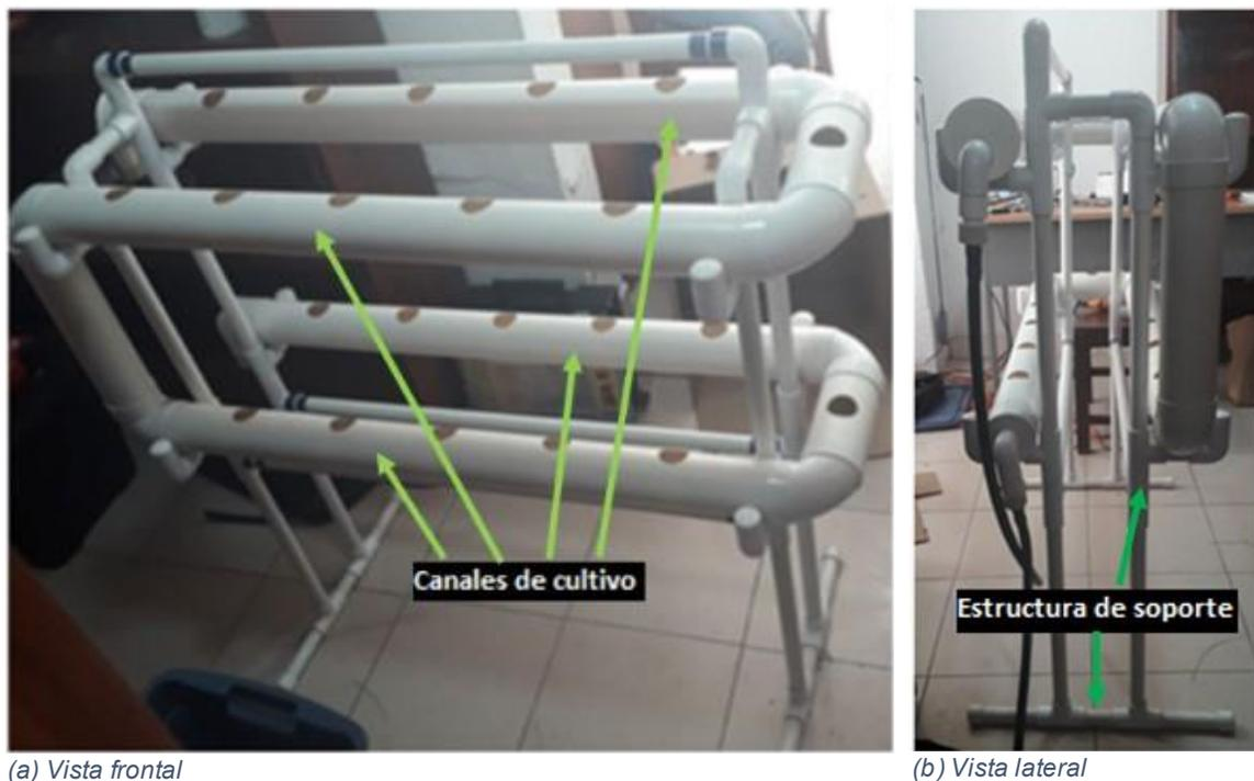
Figura 83 Estructura del sistema hidropónico
