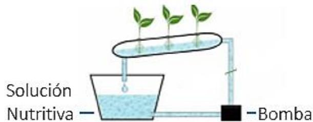
Figura 9 Esquema básico de funcionamiento de la técnica por película nutritiva
