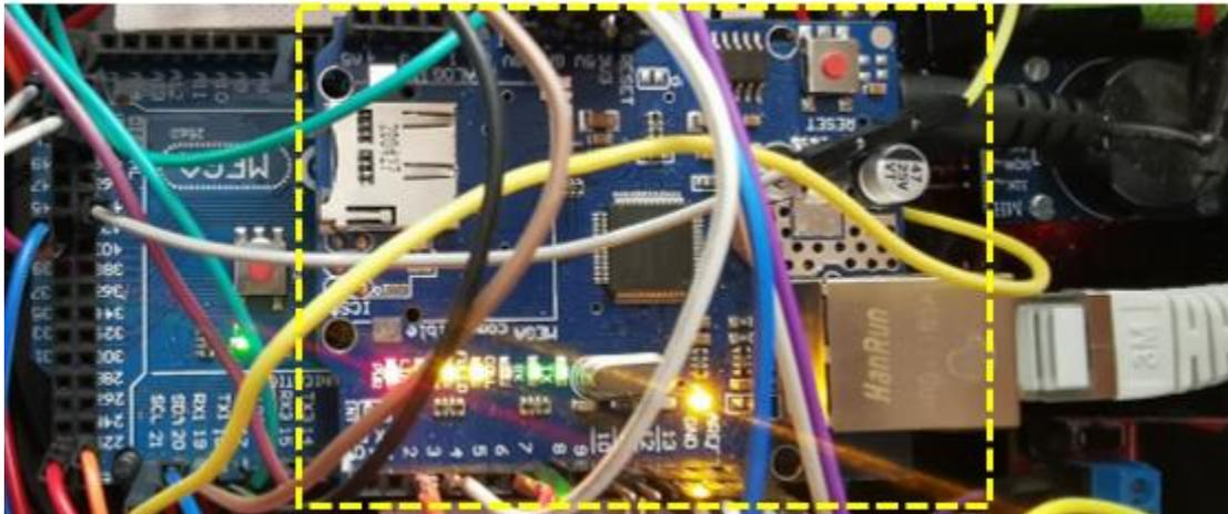
Figura 101 Montaje ethernet shield sobre Arduino Mega
