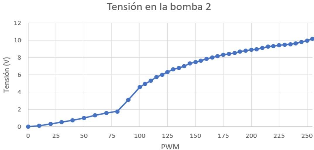
Figura 90 Mediciones de tensión en la bomba peristáltica 2
