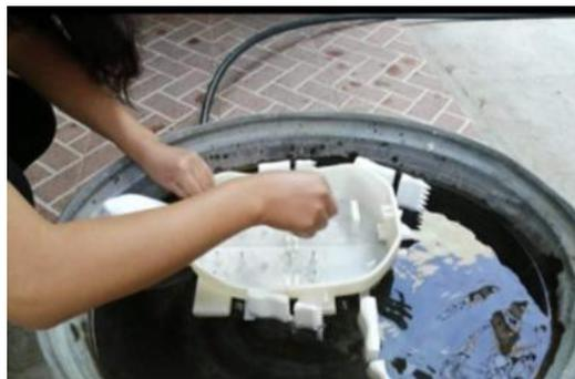
Figura 76. Prueba de Flotación con el sistema de locomoción
