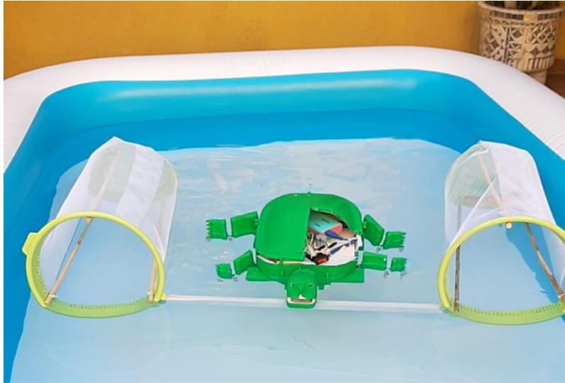
*Figura 84. Flotabilidad con todos los sistemas integrados*
