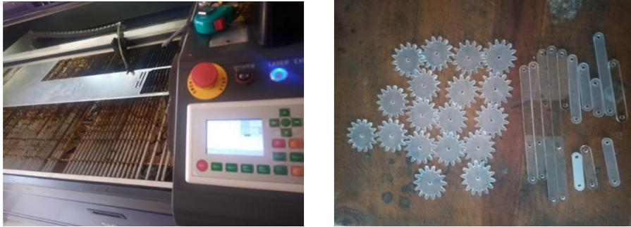
Figura 70. Corte Laser de los Eslabones y Engranajes
