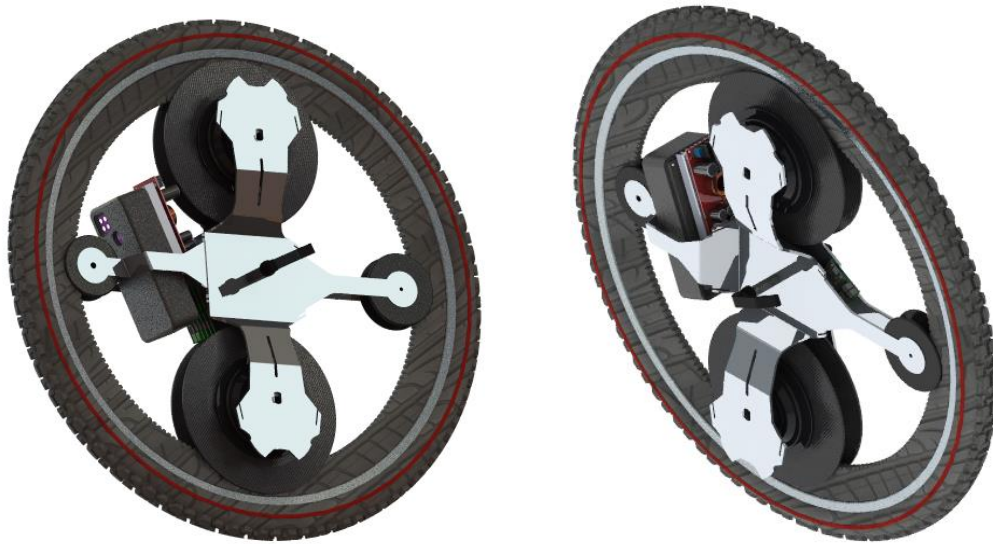
Figura 71. Ensamblaje de la rueda frontal de bicicleta generadora de energía eléctrica.
