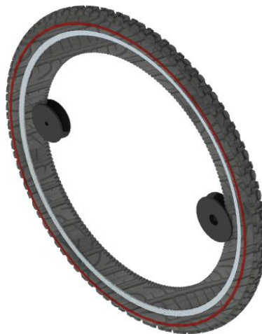
Figura 94. Ensamblaje de la banda trapecoidal C64 con las ruedas laterales tipo polea manufacturadas con plástico PLA por medio de una impresora 3D.
