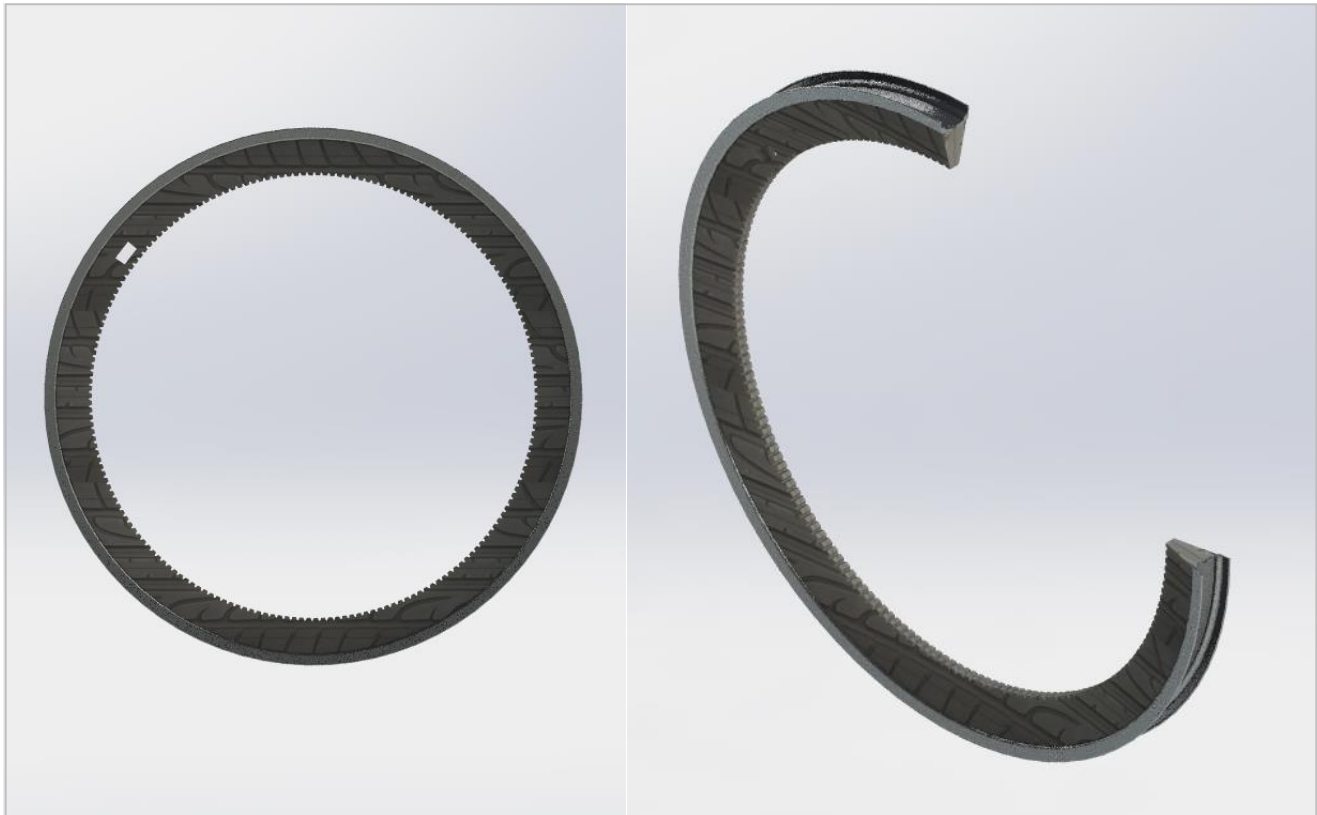
Figura 31. Riel usando una banda trapezoidal perfil C64 para la rueda frontal generadora de energía.
