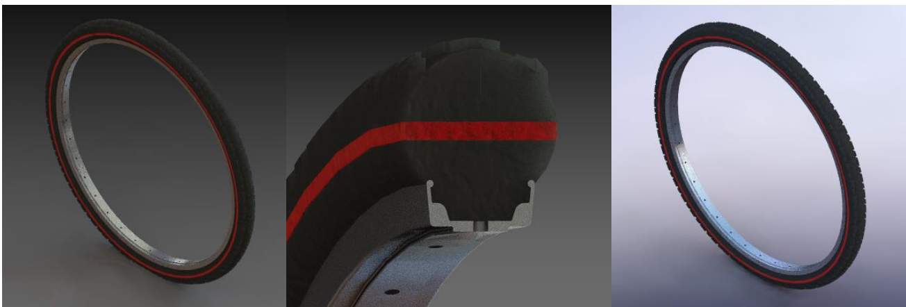
Figura 30. Modelado 3D en SolidWorks del rin y llanta utilizando la herramienta de visualización Photoview 3D.
