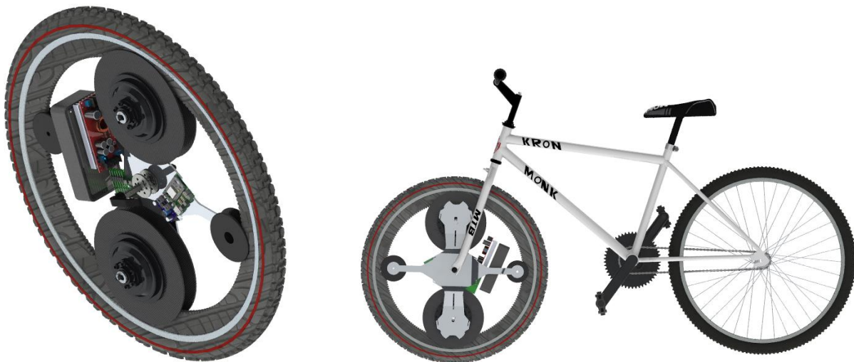
Figura 98. Ensamblaje total de la rueda frontal de bicicleta generadora de energía eléctrica.
