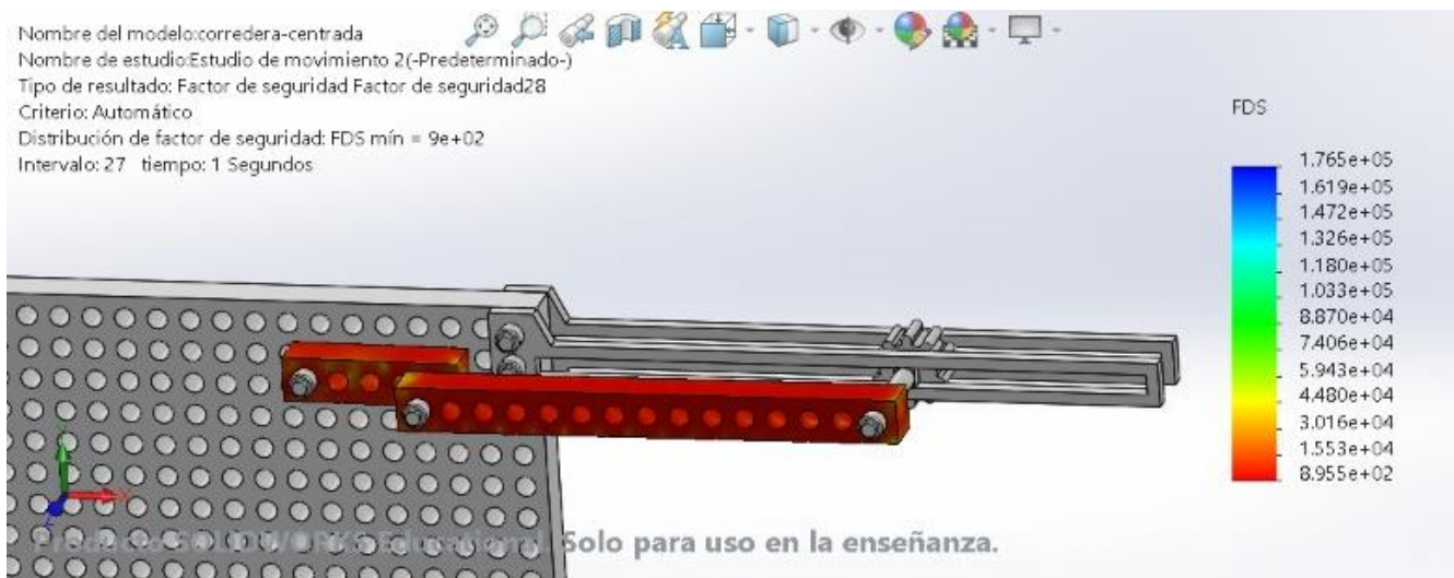
Figura 62. Factor de seguridad de la manivela
