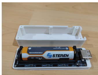
Imagen 3.12: Tarjeta de batería 18650 con caja y batería.
