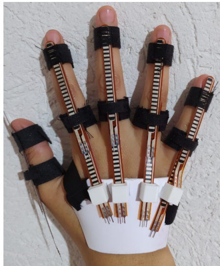
Imagen 3.1: Estructura de la mano con los 10 sensores colocados.
