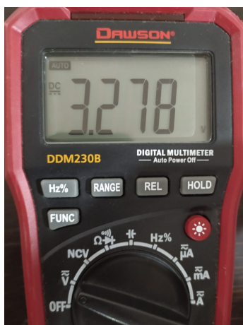
Imagen 3.13: Voltaje de salida de la tarjeta ESP32.
