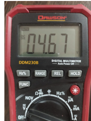
Imagen 3.10: Voltaje de alimentación de la tarjeta ESP32.
