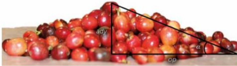
Ilustración 34 Experimento para determinar ángulo de reposo [27]
