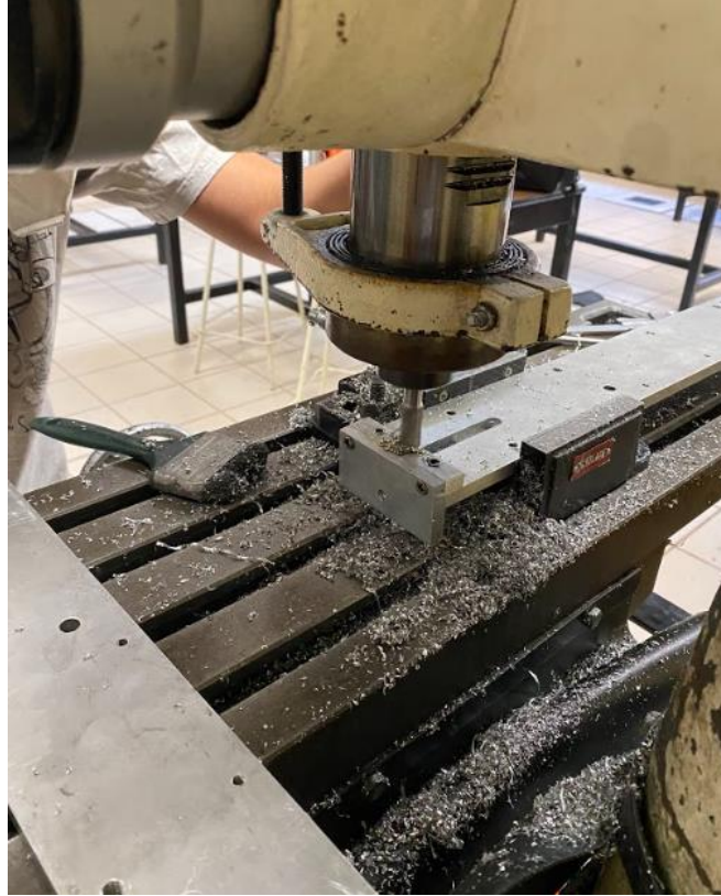
Ilustración 80 Maquinado de largueros de la banda
