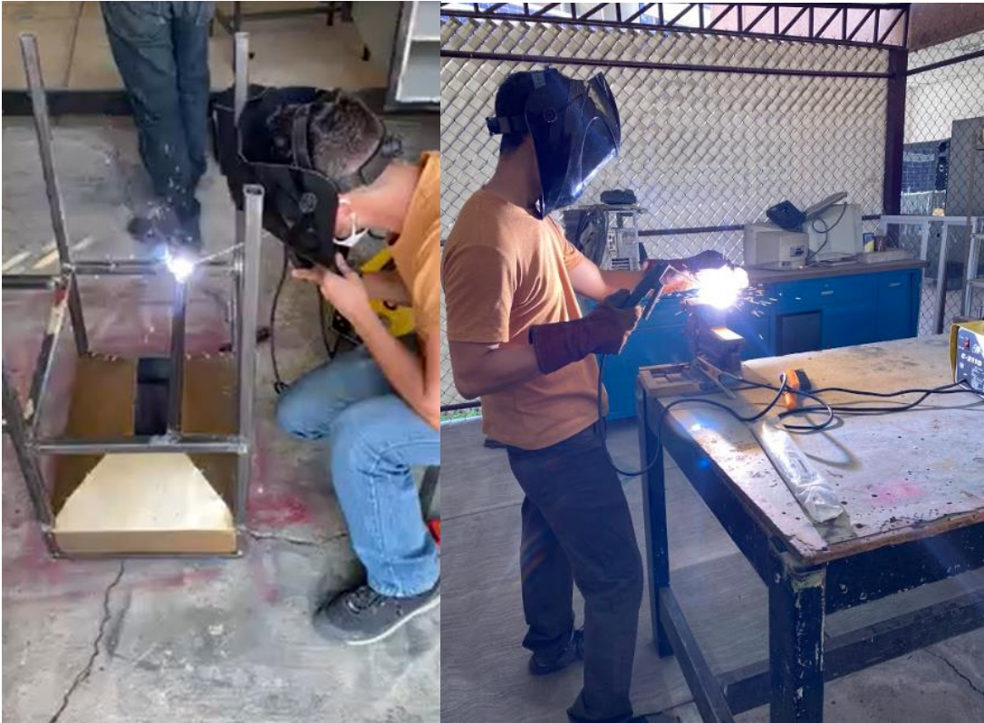
Ilustración 76 Soldado de estructura principal de la máquina
