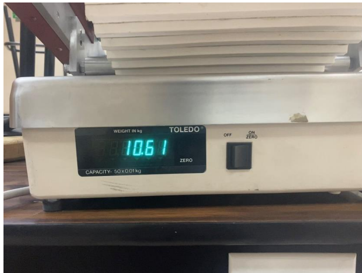
Ilustración 25 Masa total de la banda transportadora real [Elaboración propia]
