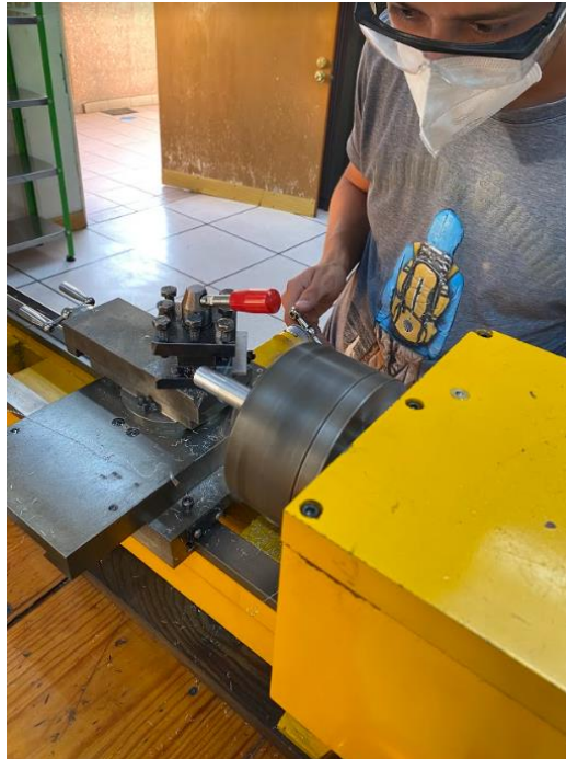
Ilustración 82 Maquinado del eje del rodillo motriz
