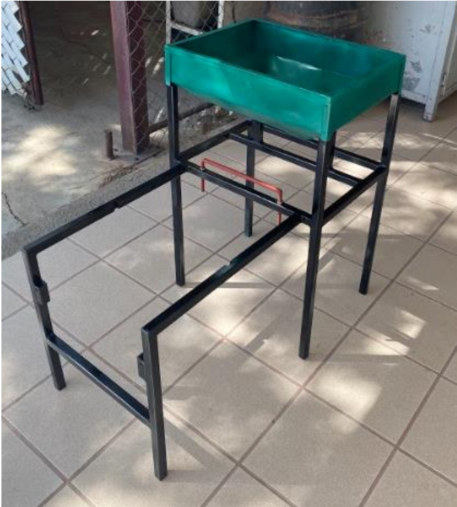
Ilustración 79 Estructura y tolva pintadas
