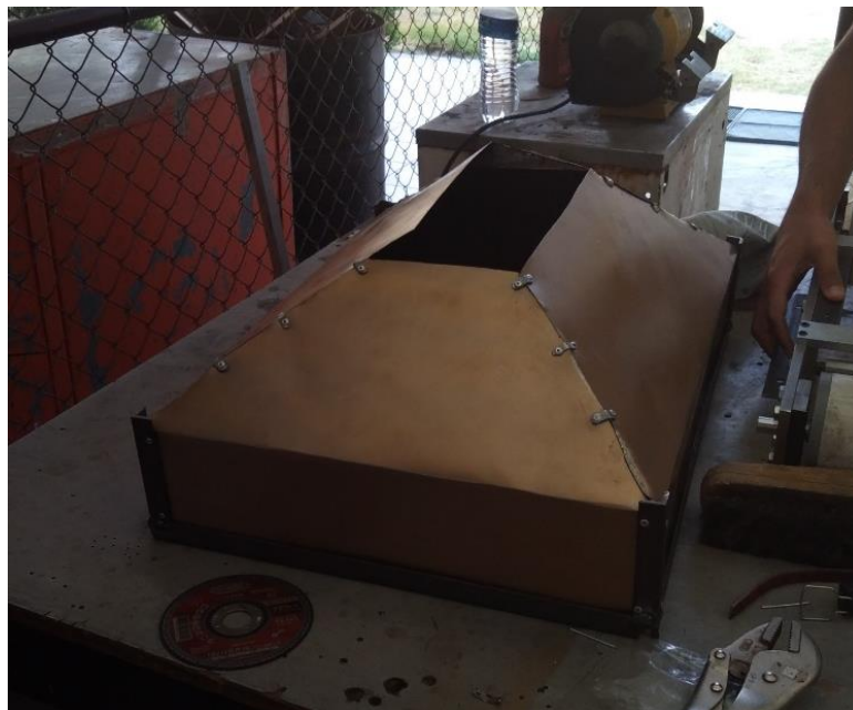
Ilustración 75 Tolva unida por remaches
