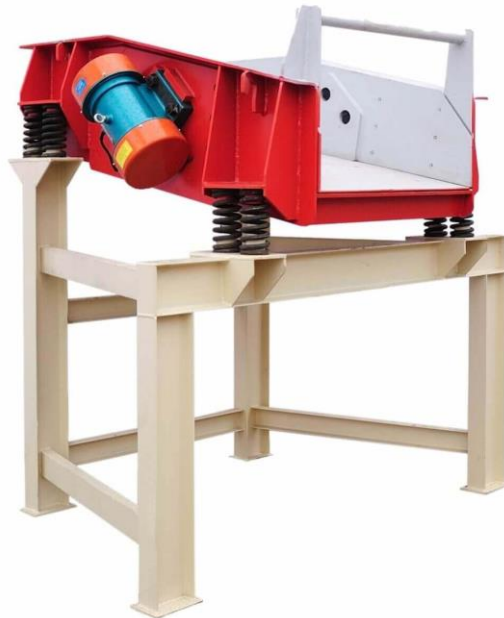
Ilustración 5 Sistema vibratorio mediante masa excéntrica-resorte [17]
