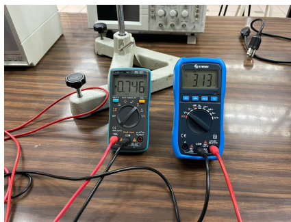
Figura 3.16: Mediciones de corriente y tensión para el cálculo de la resistencia.
