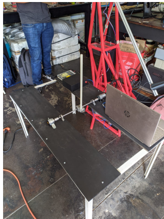
Figura 4.24: Péndulo simple alternativo a referencia \pi .
