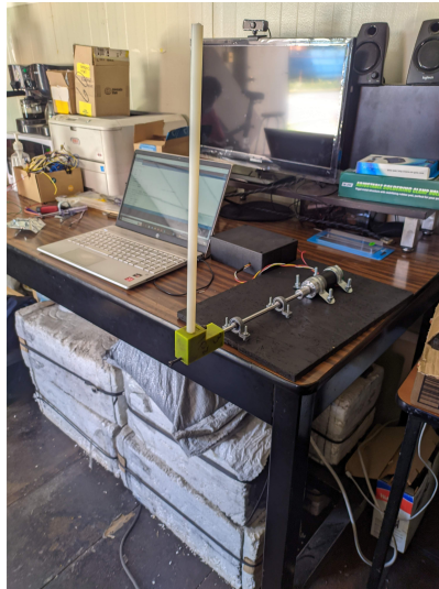
Figura 4.15: Péndulo simple con control de posición.
