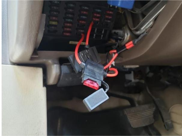
*Fusibles de protección para el prototipo. Fuente: Elaboración propia*
