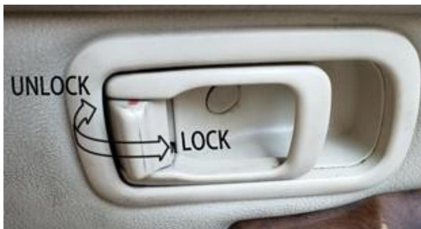
*Ilustración 12 Mando de bloqueo mecánico en el interior de la puerta
