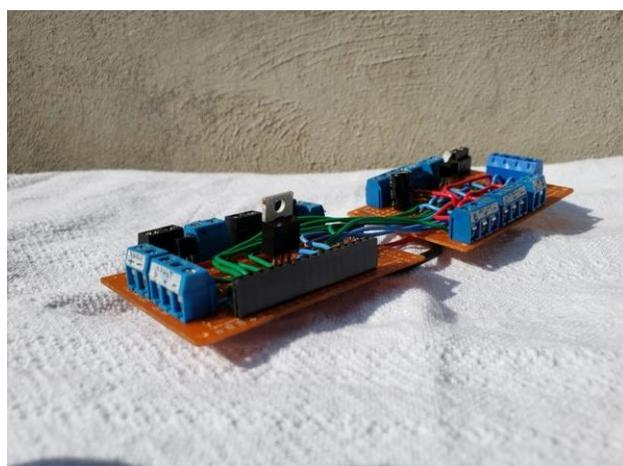
Ilustración 43 Circuito del sistema implementado en placas fenólicas
