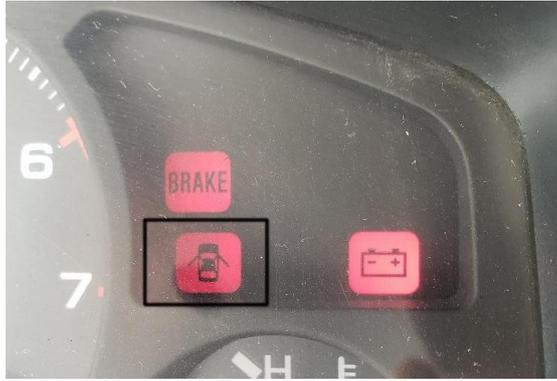
*Ilustración 9 Testigo luminoso de puertas abiertas
