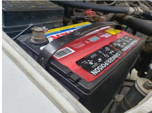
*Ilustración 14 Batería automotriz G-24
