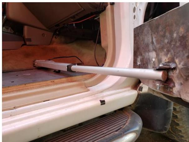
*Actuador lineal acoplado a las bases con balancín. Fuente: Elaboración propia*
