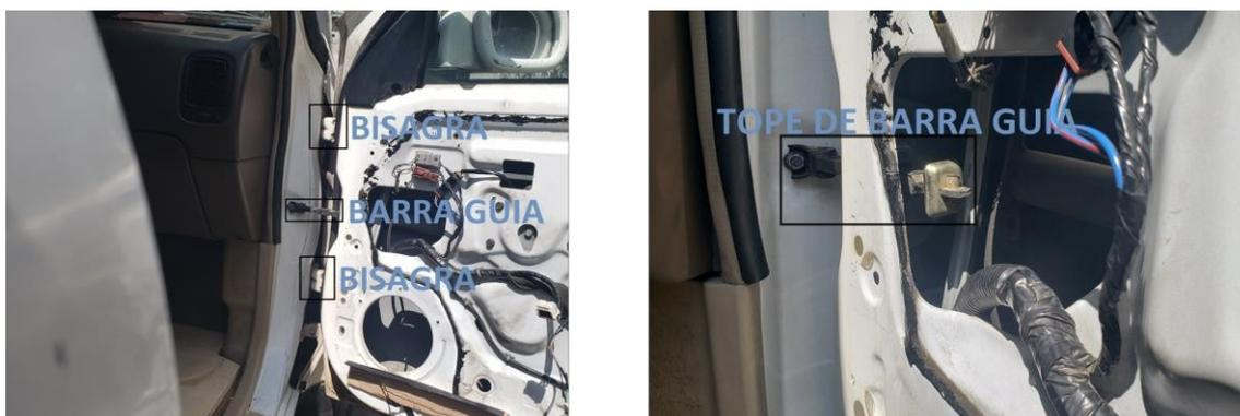
Ilustración 31 Sistema de soporte mecánico de la puerta Pathfinder 1998
