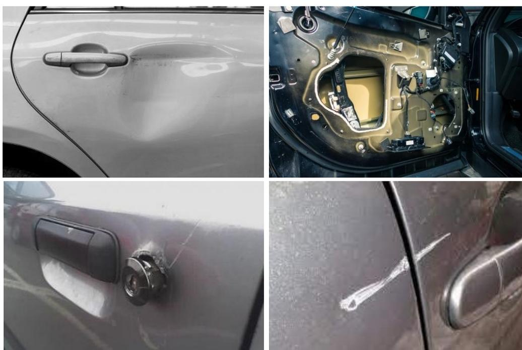
*Ilustración 2 Daños al vehículo (Abolladura<sup>6</sup>, internos<sup>7</sup>, mecanismo de bloqueo<sup>8</sup> y pintura<sup>9</sup>)
