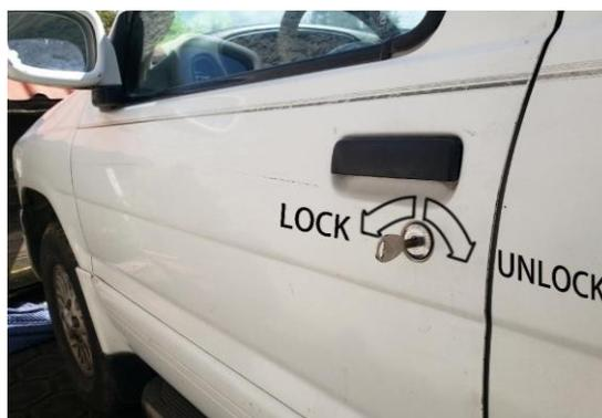
*Ilustración 11 Sistema de apertura y cierre para llave
