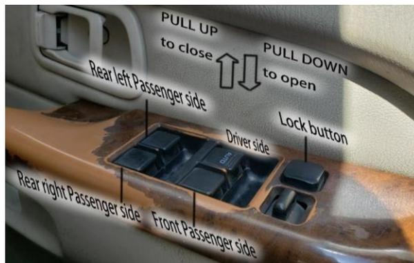
*Ilustración 10 Panel de control de ventanas.
