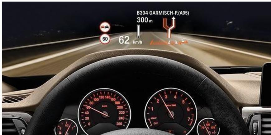
**Ilustración 19.** Sistema Head-Up Display de BMW [Ilustración], por Motori Redazione, 2019, Avvenire (<https://www.avvenire.it/economia/pagine/controllo-vocale-e-display-sul-parabrezza-l-auto-cambia>)
