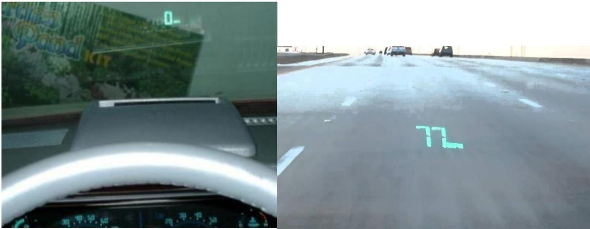
*Ilustración 25. Sistema Head-Up Display del Oldsmobile Cutlass Supreme y del Pontiac Grand Prix, respectivamente [Ilustración], por Soler Alex, 2018, SPORT (<https://www.sport.es/es/noticias/automocion/head-up-display-que-es-como-funciona-6585510>)*
