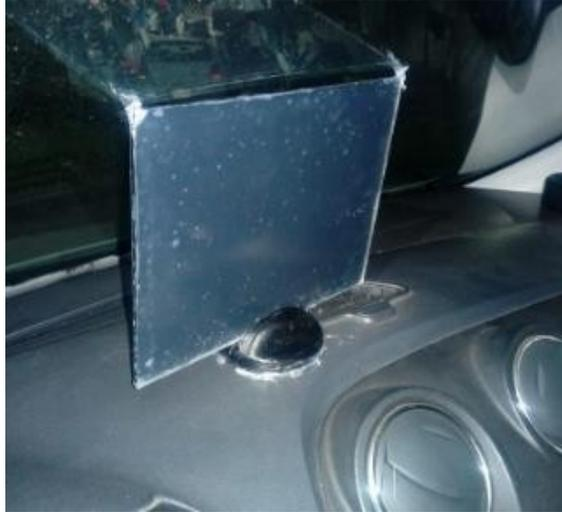
*Fotografía 10. Cristal colocado sobre la base, y esta a su vez está pegada sobre el tablero*
