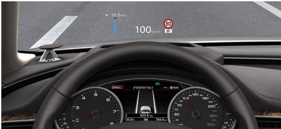
*Ilustración 20. Sistema Head-Up Display convencional [Ilustración], por Audi media center, 2016, AUDI (<https://www.audi-mediacycenter.com/en/photos/detail/head-up-display-42306>).*
