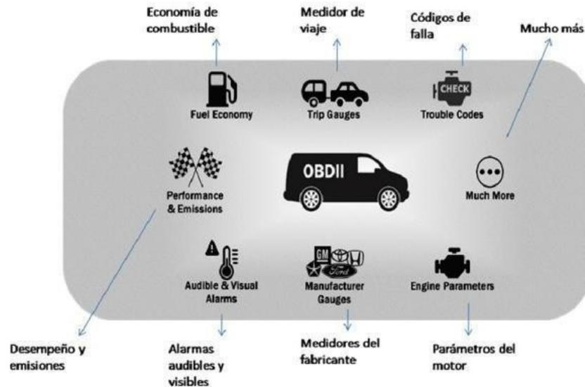
*Ilustración 4. Parámetros que abarca el sistema OBD II [Ilustración], por Alfaro Daniel, 2017, gob ([https://www.gob.mx/cms/uploads/attachment/file/187221/diagnosticoabordo\\_1\\_260117.pdf](https://www.gob.mx/cms/uploads/attachment/file/187221/diagnosticoabordo_1_260117.pdf)).*
