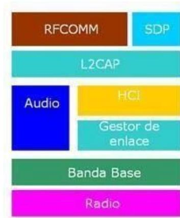
*Ilustración 13. Pila de protocolos Bluetooth [Ilustración], por Electrónica Fácil, 2018, Electrónica Fácil (<https://www.electronicafacil.net/tutoriales/Protocolos-Bluetooth.php>)*
