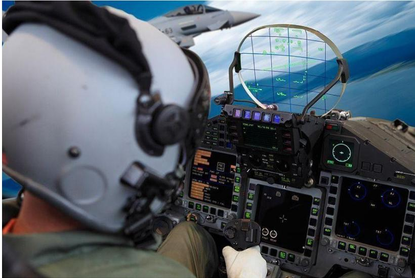
**Ilustración 18.** Head-Up Display montado en un avión de guerra [Ilustración], por Howard Bill, 2012, Extremetech (<https://www.extremetech.com/extreme/124847-bmws-full-color-hud-distraction-minimizer-of-distractions-or-costly-tech-gadget>)
