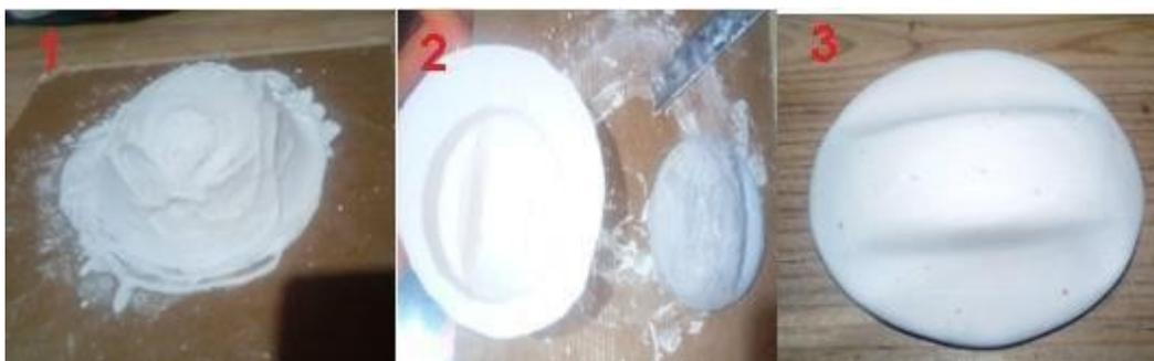
*Fotografía 9. 1) Se realizó un molde de yeso con la forma de la base deseada. 2) Se obtuvo el molde de la base. 3) Se rellenó el molde de yeso con resina epoxica para que finalmente se obtuviera la base final.*
