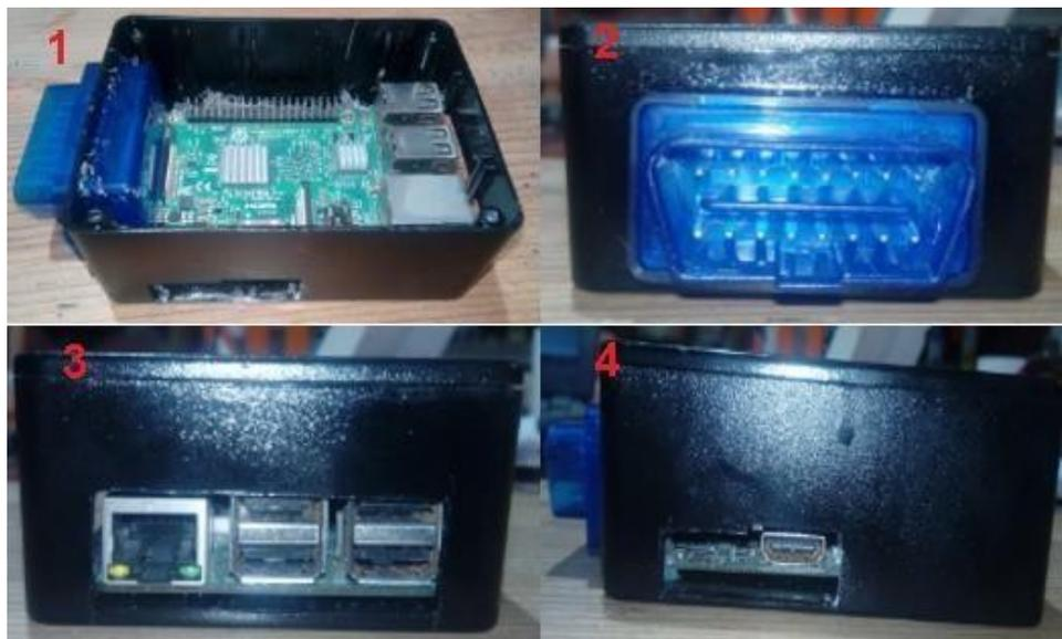
**Fotografía 4.** 1) Muestra la distribución interna de la Raspberry y el escaner ELM327 dentro del gabinete de plástico. 2) Vista frontal del sistema. 3) Vista trasera del sistema. 4) Vista lateral izquierda.
