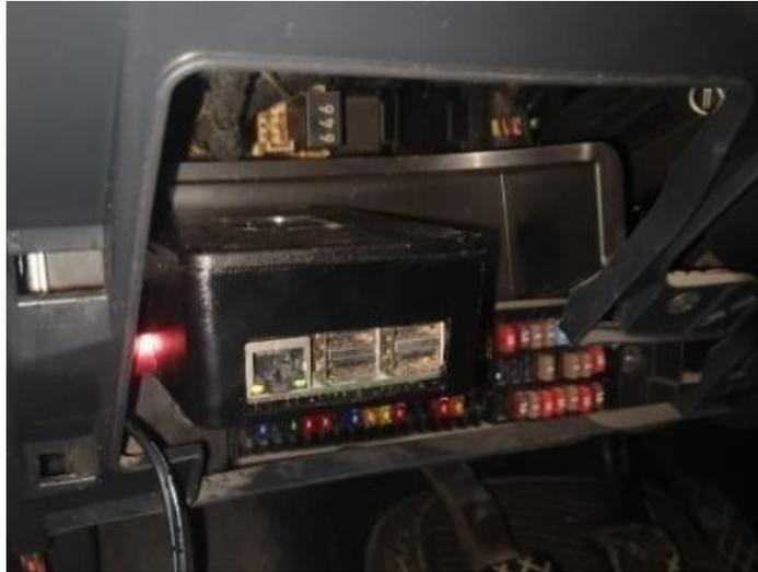
*Fotografía 5. Sistema Raspberry PI 3B - ELM327 conectado al puerto OBD II de un Seat Ibiza 2015*
