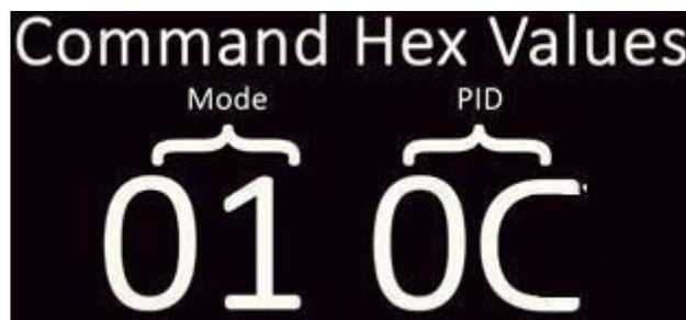
*Ilustración 31. Ejemplo de comando completo para la obtención de la velocidad del vehículo [Ilustración], por Tinkernut, 2018, Youtube (<https://www.youtube.com/watch?v=DABytIdutKk&t=26s>)*
