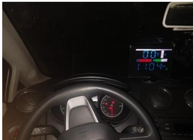
*Fotografía 12. Vista del conductor con el sistema de proyección montado*
