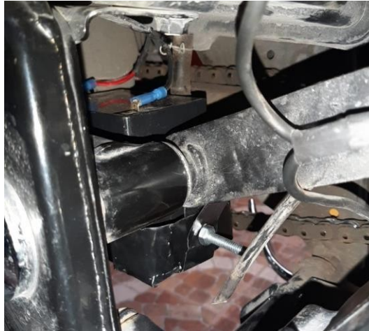
Figura 36. Batería externa instalada. (Imagen de autoría propia)
