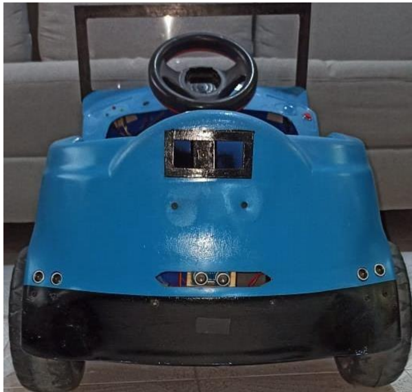
Figura 50. Sensores, servomotor y cámara instalados.
