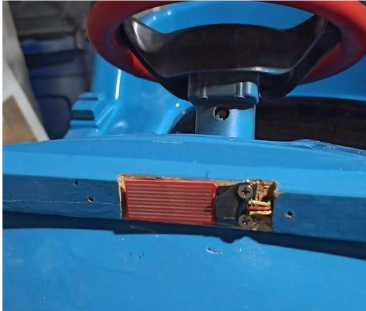
Figura 51. Sensor de agua instalado.
