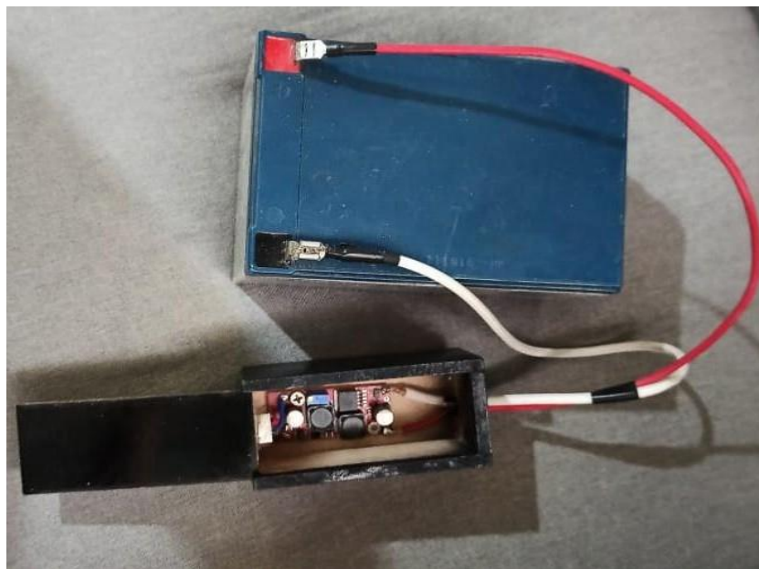
Figura 52. Reductor de voltaje y pila de moto 1.
