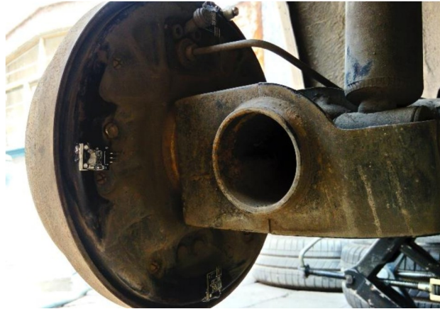
Figura 6. Sensores montados sobre el tambor de la rueda izquierda trasera.
