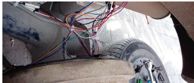
Figura 7. Conexiones sobre placa de pruebas fijada sobre la suspensión.
