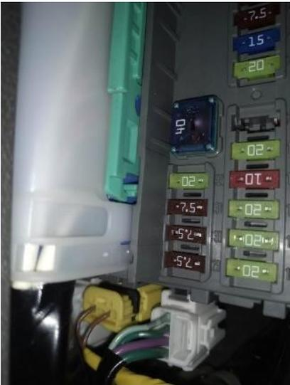
Figura 31 Fusible de 7.5 amperes en la caja de fusibles
