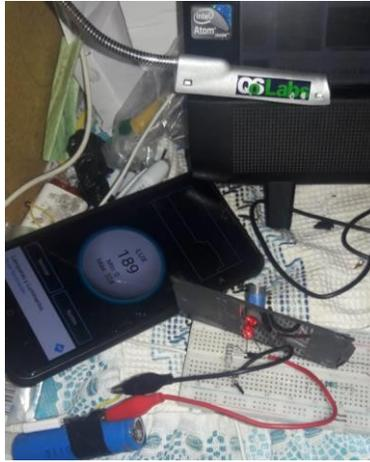
*Figura 38 Fotorresistencia con luz artificial*
