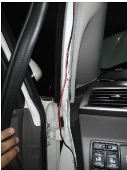
*Figura 34 Paso de cable por pilar delantero izquierdo*
