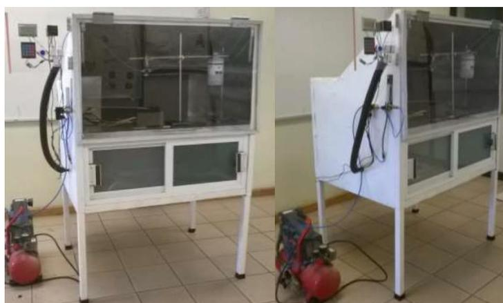
Figura 6. Equipo para la deposición de películas por spray pirolisis.[19]
