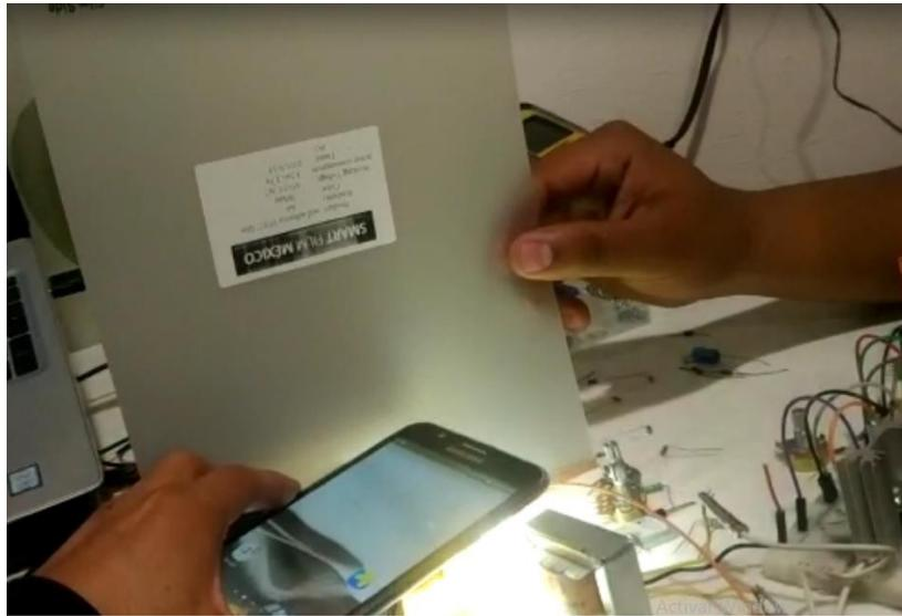
Figura 40 Película electrocrómica respondiendo a intensidad luminosa en sensor
