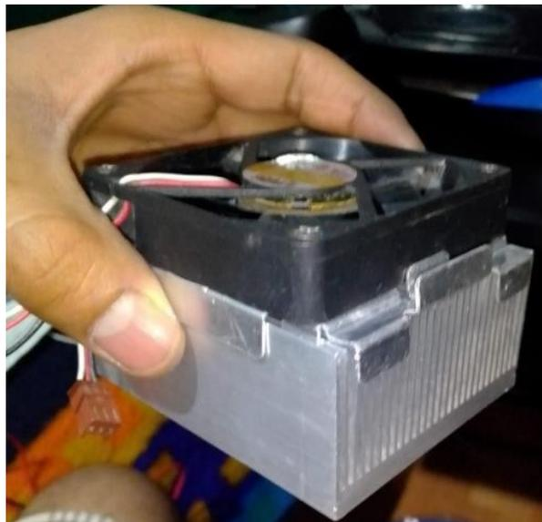
Imagen 52 Disipador de calor con ventilador.
