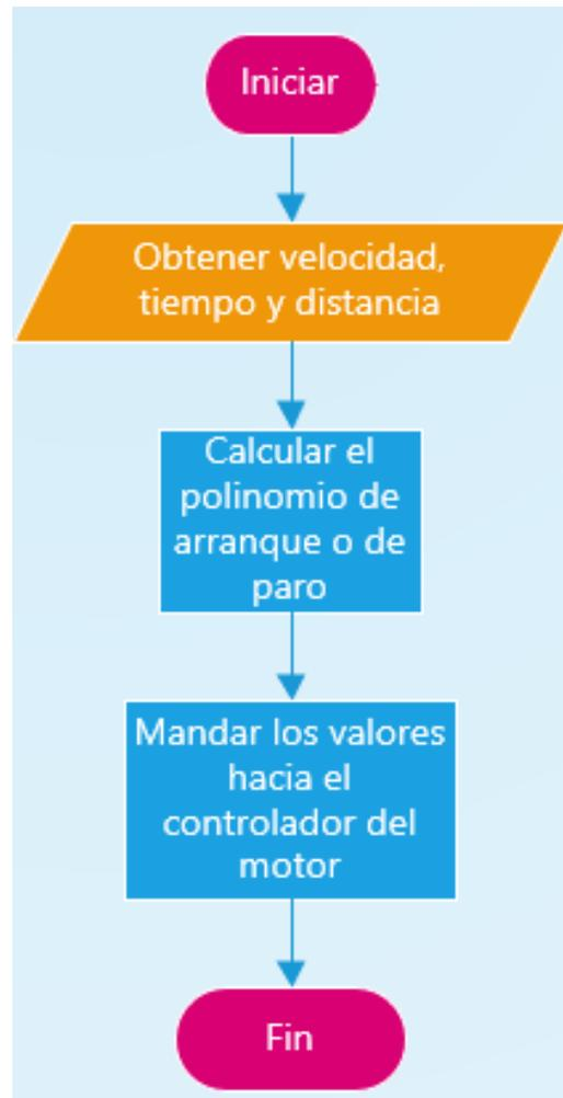
*Imagen 37 Diagrama de flujo del programa para la generación del perfil de velocidad.*
