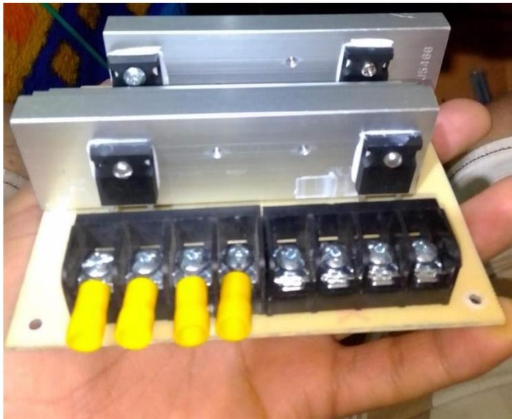
*Imagen 68 Circuito terminado con los disipadores de calor añadidos.*
