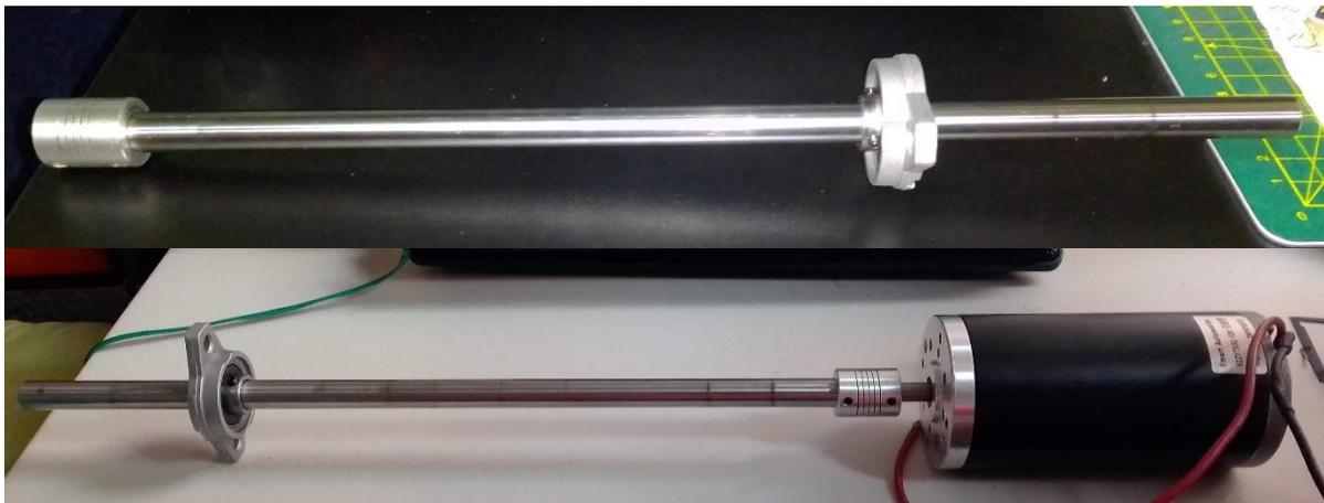
*Imagen 61 Acoplamiento del eje, acople y chumacera.*
