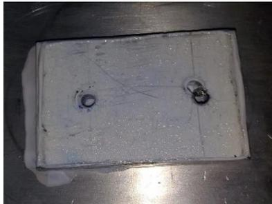
*Imagen 64 Trozo de perfil de aluminio y disipador de calor con perforaciones de 1/8".*
