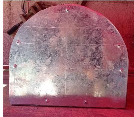
*Imagen 73. Lámina trasera colocada con una sujeción no permanente.*
