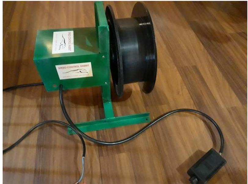
*Imagen 13 Liebre mecánica con interruptor para variar velocidad [51].*
