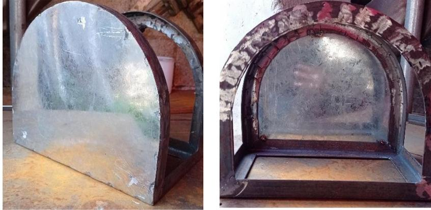
*Imagen 72. cubierta frontal soldada, desbastada y colocada.*
