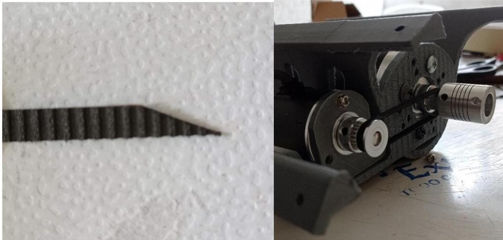
*Imagen 80 corte en diagonal de banda para ajuste y vulcanización y montaje con encoder y motor..*
