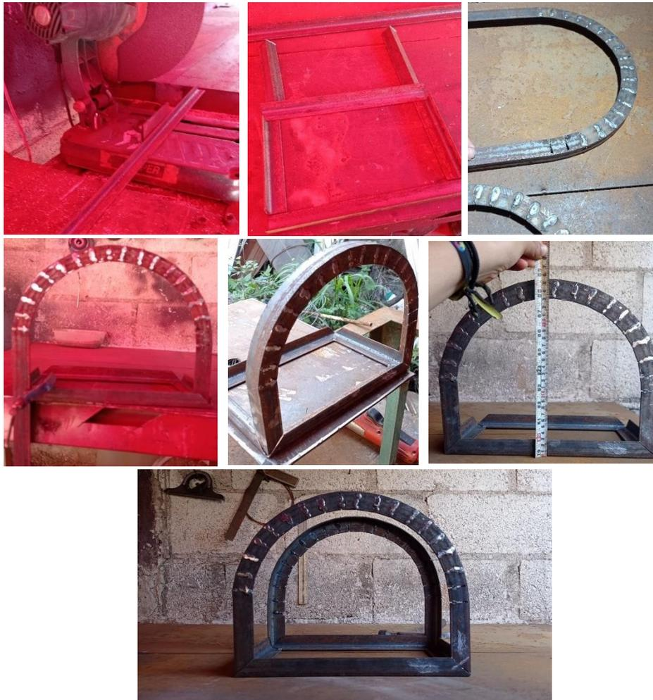
*Imagen 71. Proceso de corte y unión estructural*
