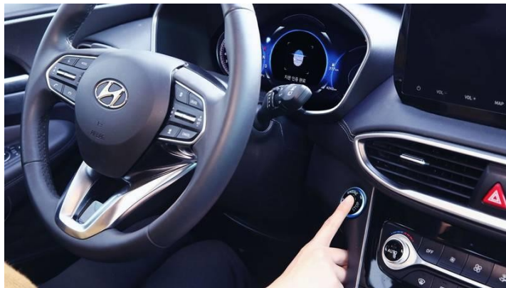
Figura 2 Encendido de motor por huella dactilar de Hyundai
