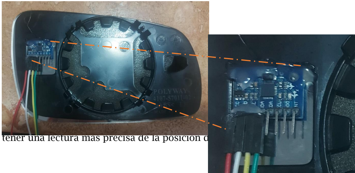
Figura 19 Posición sensor MPU6050
