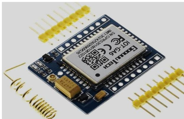
**Figura III-15.** Módulo GPRS [12].
