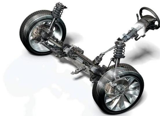
**Figura I-5** Sistema de dirección delantera [41].
