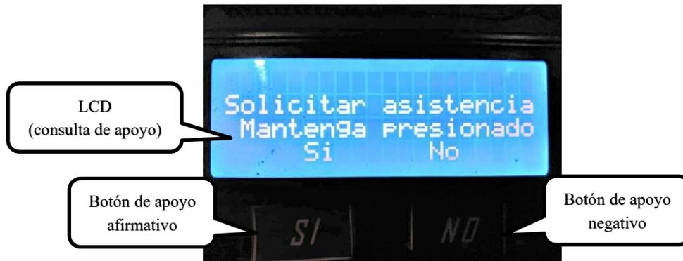
**Figura IV-3.** Interfaz gráfica con el mensaje "Solicitar asistencia. Mantenga presionado (Si / No).
