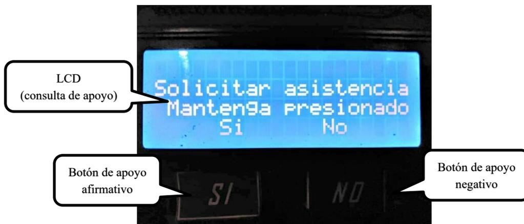
**Figura IV-18.** Interfaz gráfica con el mensaje "Solicitar asistencia. Mantenga presionado (Si / No)."
