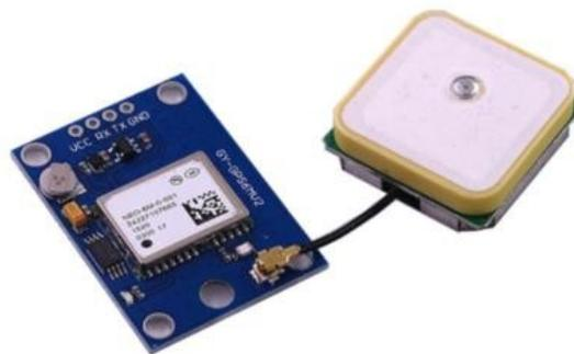
**Figura III-12.** Módulo GPS NEO6MV2 [11].
