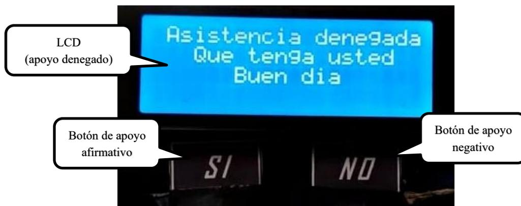
**Figura IV-4.** Interfaz gráfica con mensaje "Asistencia denegada. Que tenga usted un Buen día".
