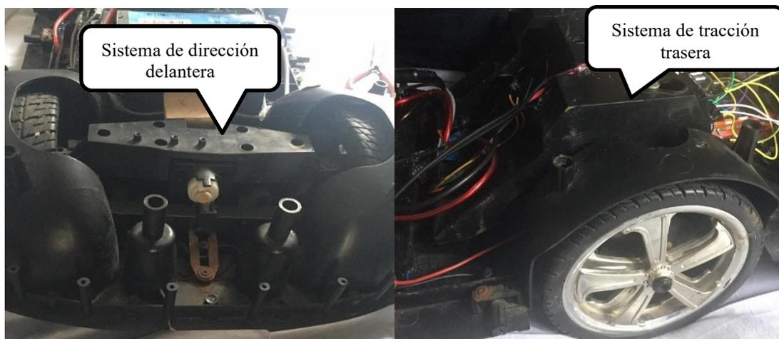
**Figura III-7.** Dirección y tracción del vehículo a escala.
