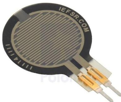
**Figura II-11.** Estructura de un FSR [29].
