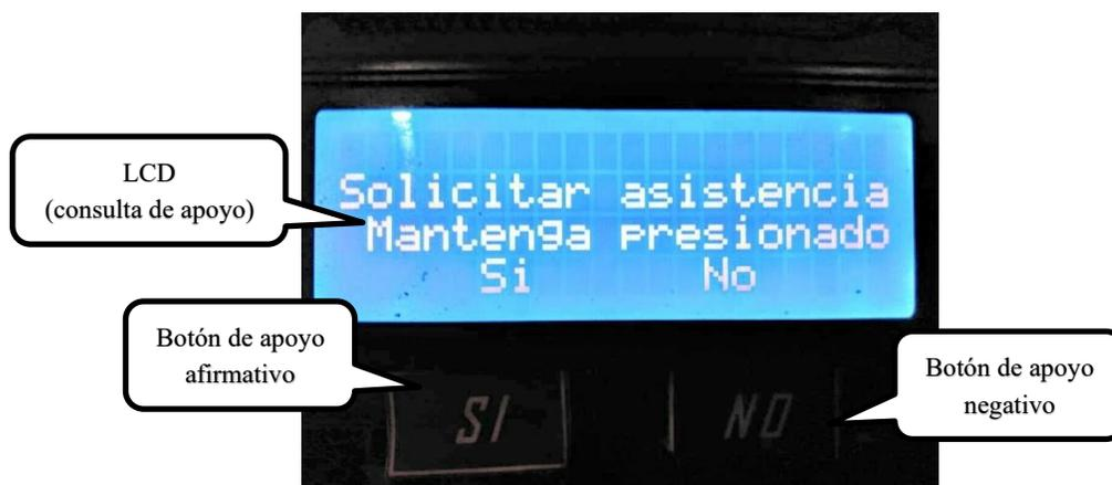
**Figura IV-13.** Interfaz gráfica con el mensaje "Solicitar asistencia. Mantenga presionado (Si / No).
