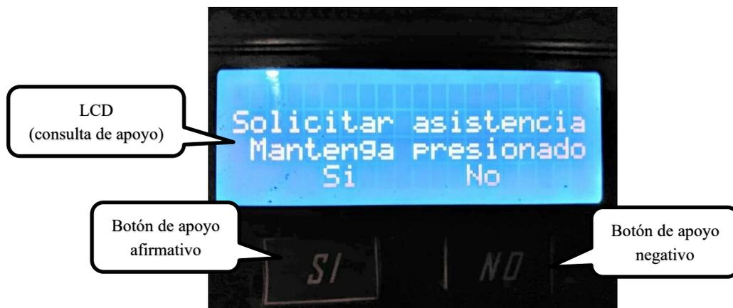
**Figura IV-8.** Interfaz gráfica con el mensaje "Solicitar asistencia. Mantenga presionado (Si / No)".
