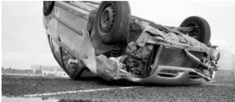
Figura II-3. Colisión tipo vuelco [19].
