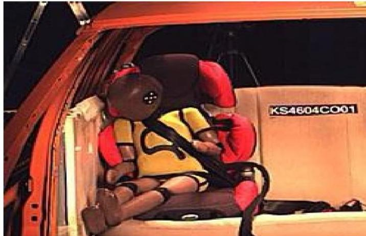
**Figura II-2.** Simulación de impacto lateral [19].
