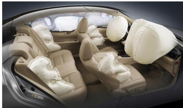
**Figura I-12.** Sistema de bolsas de aire de un vehículo [45].
