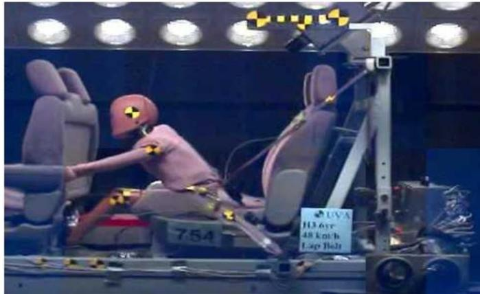
**Figura II-1.** Simulación de impacto frontal [19].
