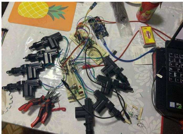
Figura 14. Conexión física del circuito de potencia y los solenoides.
