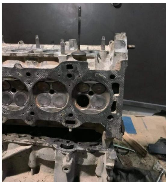
*Figura 28. Maqueta-motor limpia y válvula.*
