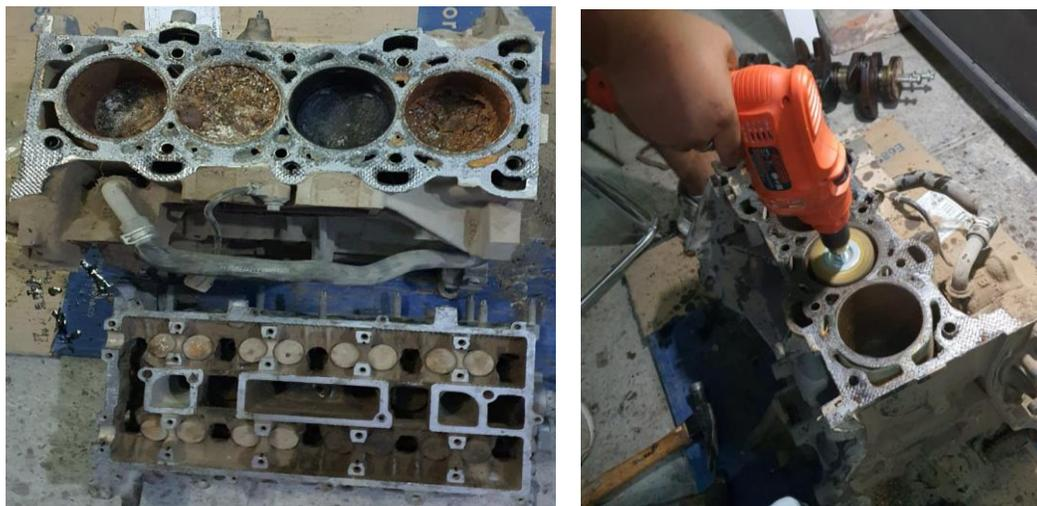
*Figura 27. Limpieza interna de la maqueta-motor.*
