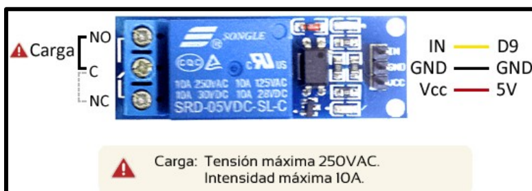
Figura 13. Esquema de montaje de un módulo relé. [21]
