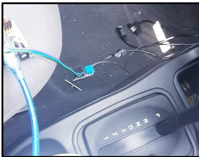
Figura 62. Relevador Activado debido a que el sensor no registra presencia de alcohol.
