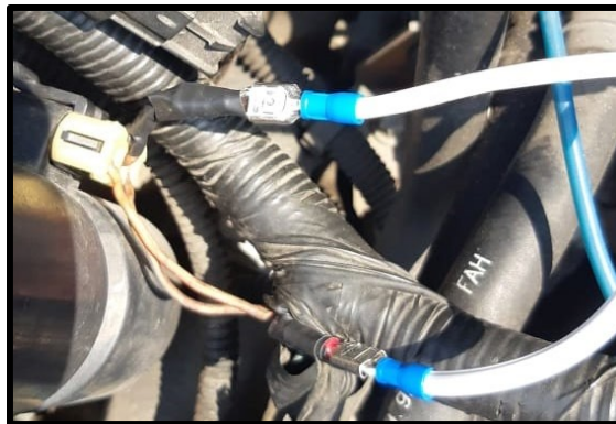
Figura 55. Cables instalados en la bobina de encendido hacia el interior del automóvil.
