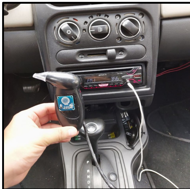
Figura 69. Sistema instalado en un automóvil Chevy 2006.5.3 Bloqueo y desbloqueo del encendido con un mensaje en específico
