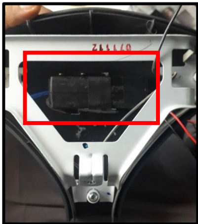
Figura 96. Sistema de medición de ángulos montado en la tapa del claxon.
