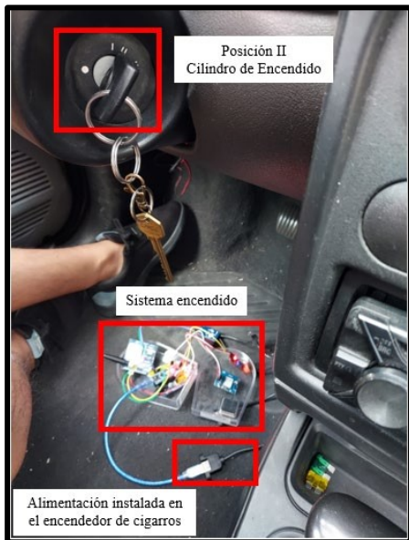
Figura 61. Llave en la posición II, con el sistema ya energizado.
