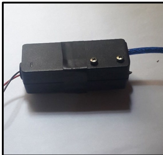
Figura 93. Carcasa cerrada y sellada para su protección.
