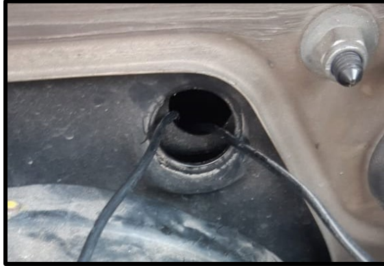
Figura 56. Orificio por donde se metieron los cables dentro del habitáculo.
