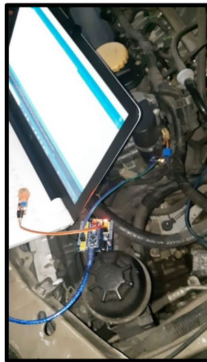
Figura 48. Sistema base de bloqueo en el que se muestra que el relevador está activado y no hay presencia de alcohol.
