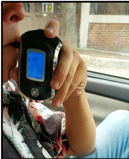
Figura 102. Concentración calculada en mg/L que indica el alcoholímetro digital.
