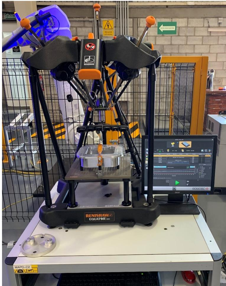
*\*Equipo Equator para inspección y medición de piezas manufacturadas*
