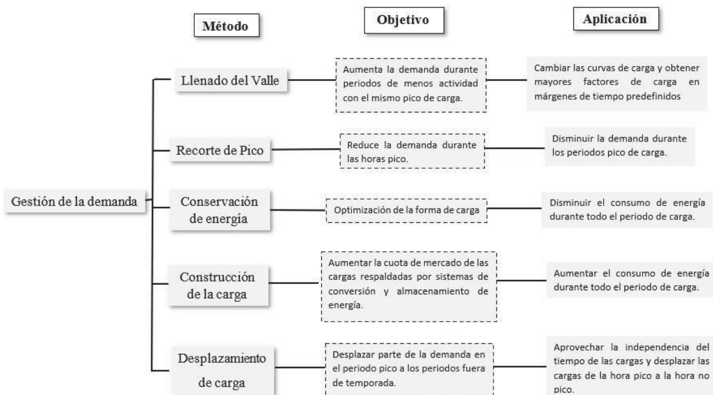
Figura 2.8. Esquema de los métodos usados para la gestión de la demanda. [1]
