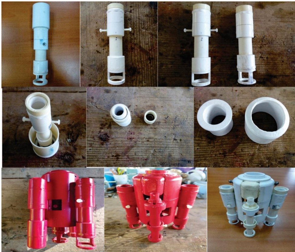
Figura 31. Dispositivo sujetador de los sensores fabricado en PVC
