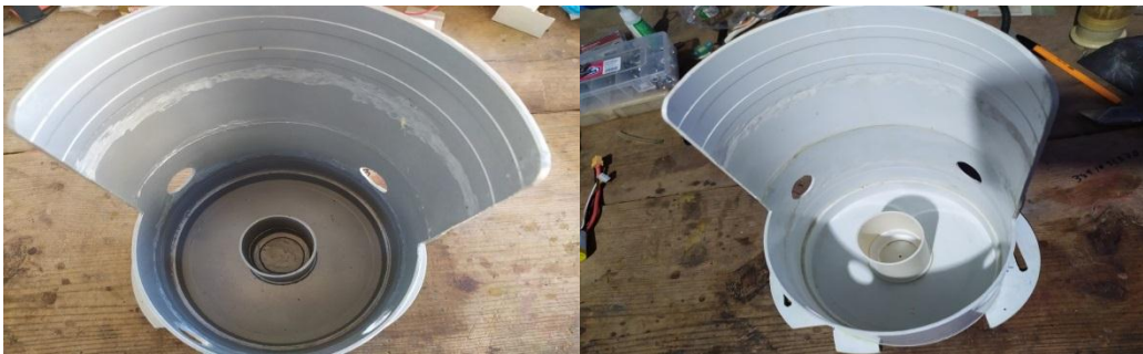
Figura 35. Base encargada de proteger los sensores cuando están en reposo
