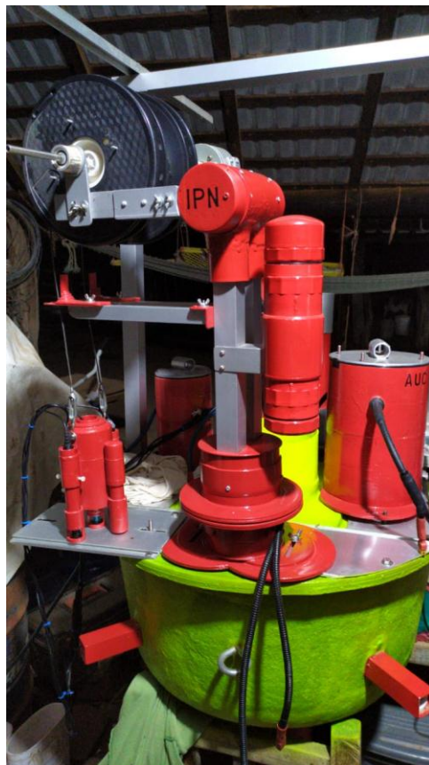
Figura 34. Sistemas de engranes empotrados en la boya
