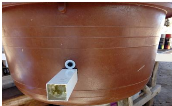
Figura 4. Anclajes de aluminio fijados con tornillos de acero inoxidable
