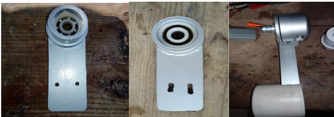
Figura 16. motor a pasos instalado utilizando dos tornillos de acero inoxidable y base con balero de plástico de 8 mm
