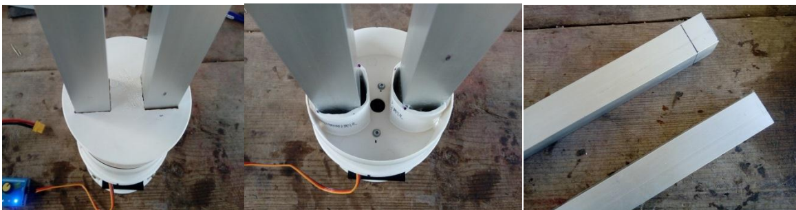
Figura 13. Fabricación de la estructura base del brazo apartir de perfiles de aluminio
