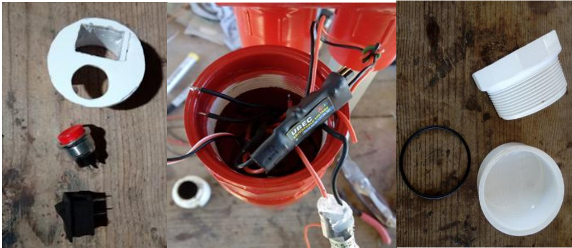
Figura 18. Cápsula fabricada con PVC y sistema enrroscable mediante coples hembra y macho además de la instalación del botón de encendido y reset
