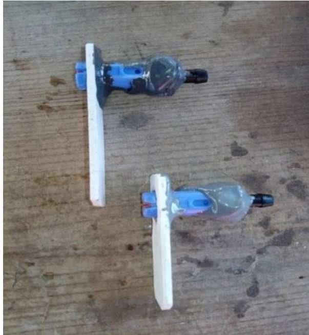
Figura 29. Boquillas de porcelana con sus respectivos coples de entrada de agua instalados
