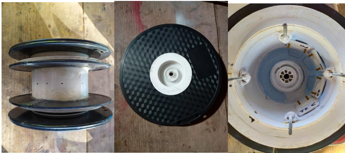
Figura 30. Polea encargada de enrollar los cables y sostener las tarjetetas de los sensores
