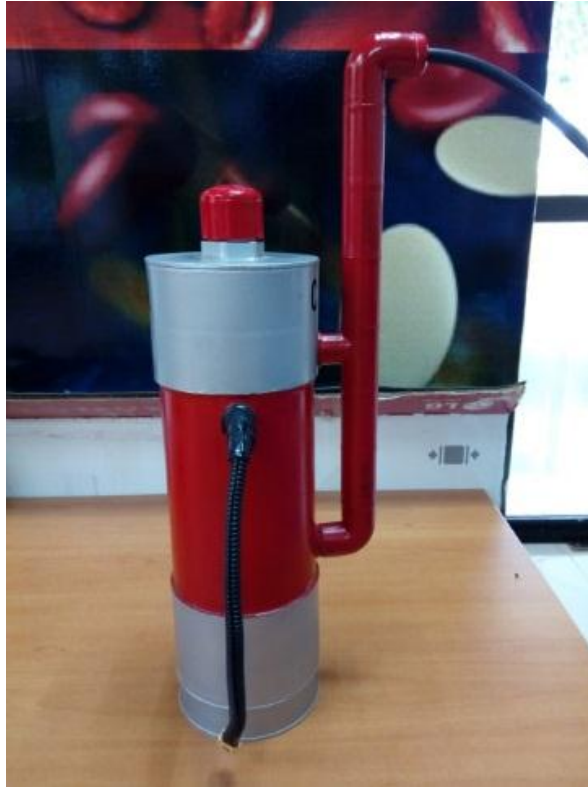
Figura 28. Contenedor de agua destilada completamente terminado con su respectivo conector y manguera distribuidora
