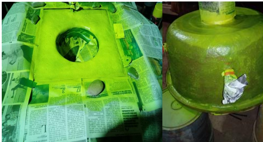
Figura 8. Proceso de pintado de la boya con una pintura amarilla fluorescente
