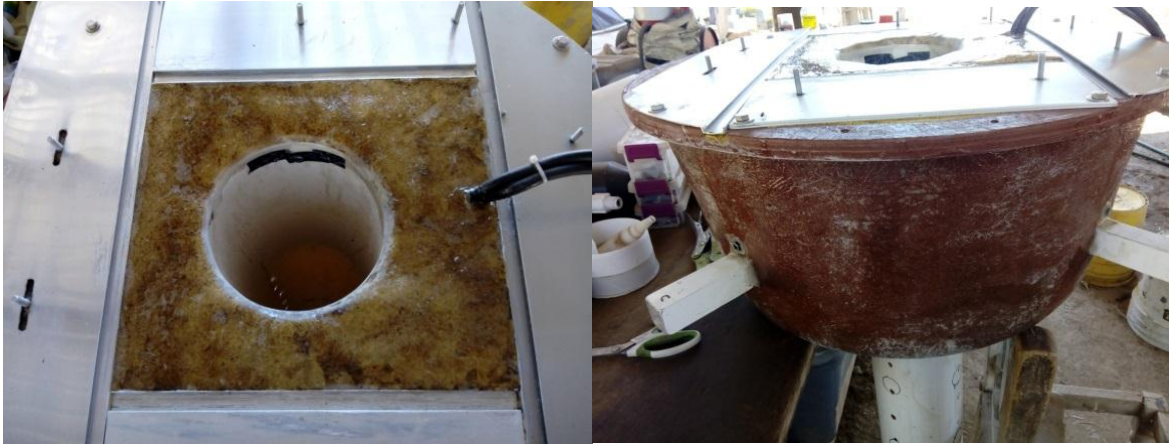
Figura 7. Detallado de la fibra de vidrio y aplicación de una capa de resina
