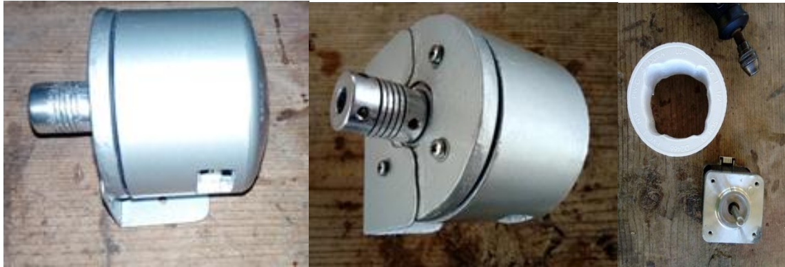
Figura 15. Fabricación de la base del motor a pasos a partir de un tubo de PVC de 2 pulgadas y una base de aluminio
