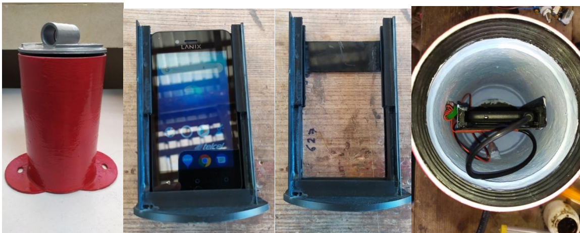
Figura 37. Contenedor de PVC para proteger al celular y base a medida del mismo impresa en 3D
