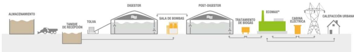
Fig. 11. Planta a biogás destinada al sector agrícola. [11]
