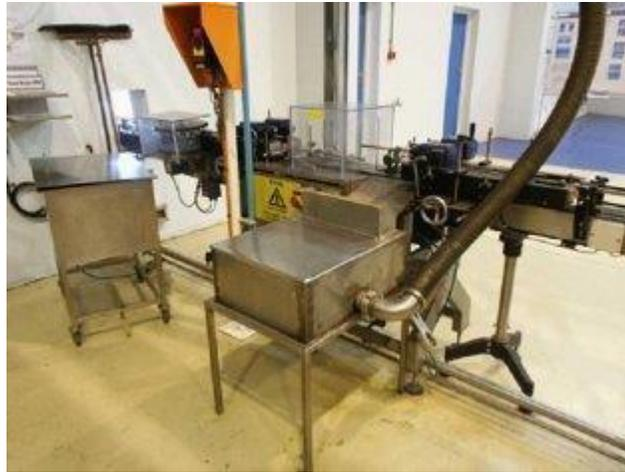
Figura 12: Máquina de verificación del peso adecuado de la lata.[Fuente: González y Rangel].
