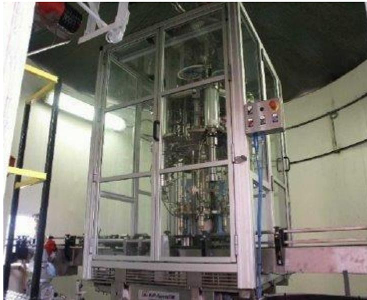
**Figura 10: Máquina de llenado de Gas LP dentro de la sala de Gasificado. [Fuente: González y Rangel].**
