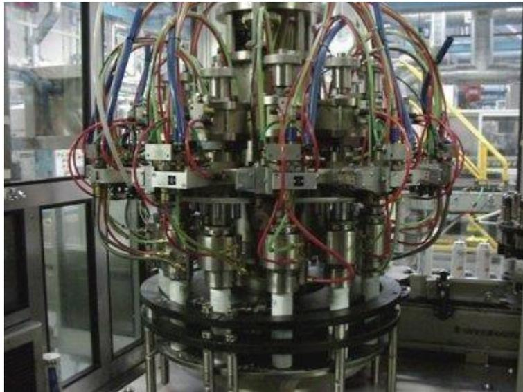
**Figura 9: Máquina engarzadora o de sellado de la lata con la inserción de la válvula.[Fuente: González y Rangel].**
