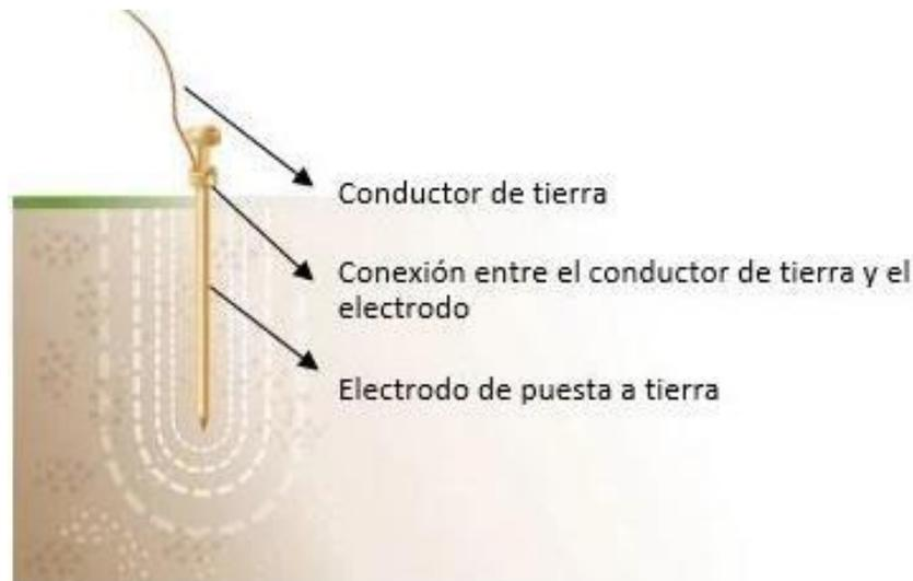
Figura 35: Componentes de un sistema de puesta a tierra. [Fuente: www.elvatron.com]
