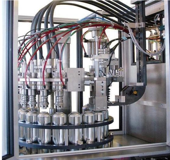
**Figura 6: Llenado de latas vacías con la mezcla de etanol con fragancia. [Fuente: González y Rangel].**
