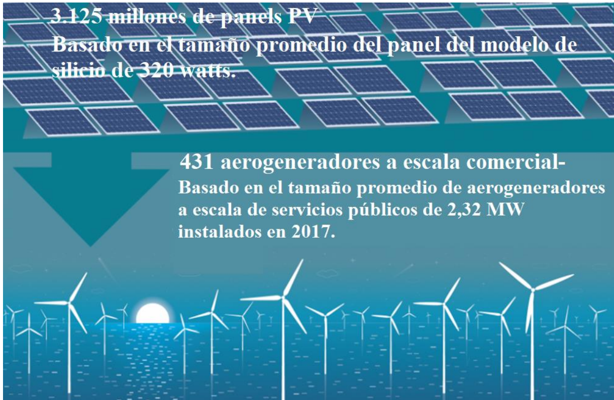
Figura 2.18 Equivalencia de energía producida por un típico reactor nuclear comercial [NE, 2022].
