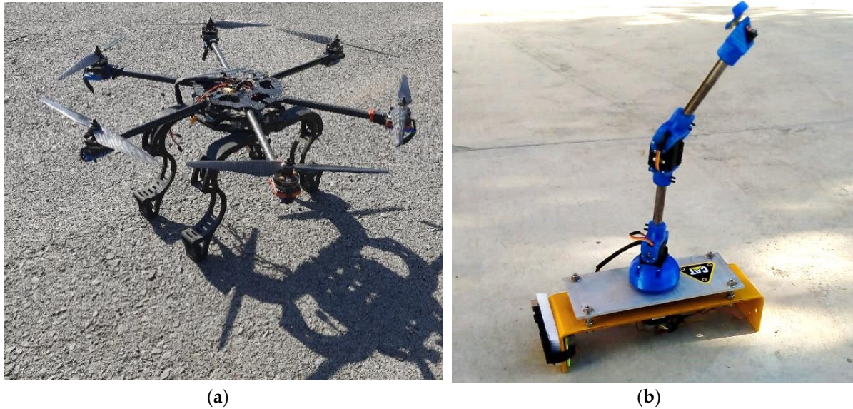
Figura 26. Sistema físico: (a) UAV hexarrotor; (b) Manipulador planar.
