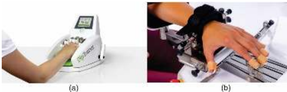
Figura 2.3. Dispositivos de rehabilitación de mano tipo efector final. (a) DigiTrainer [56], (b) Amadeo [57].
