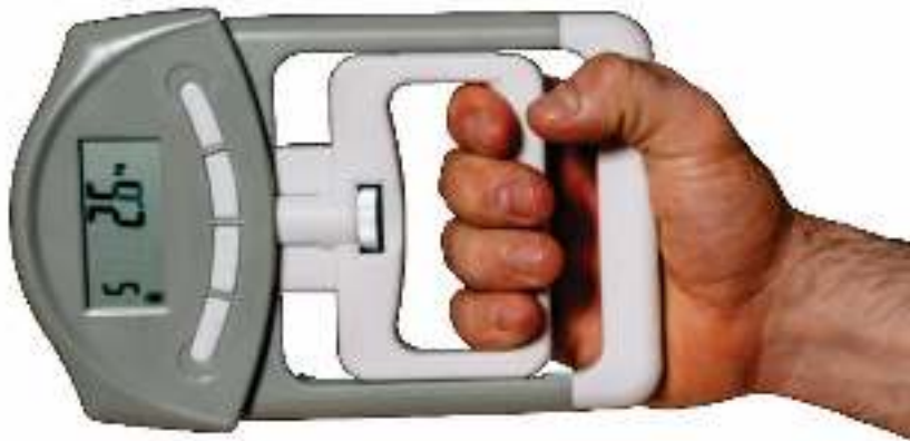
Figura 4.8. Dinamómetro digital para medir la fuerza de agarre.
