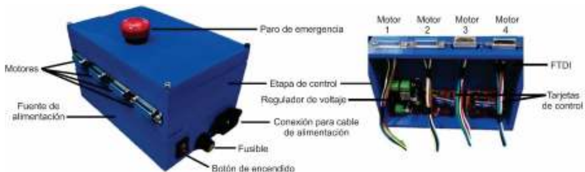
Figura 3.3. Gabinete de control.
