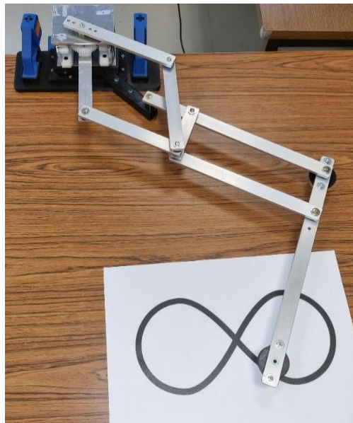
Figura 6.10 Integración del prototipo de la ARV al mecanismo de cinco barras.
