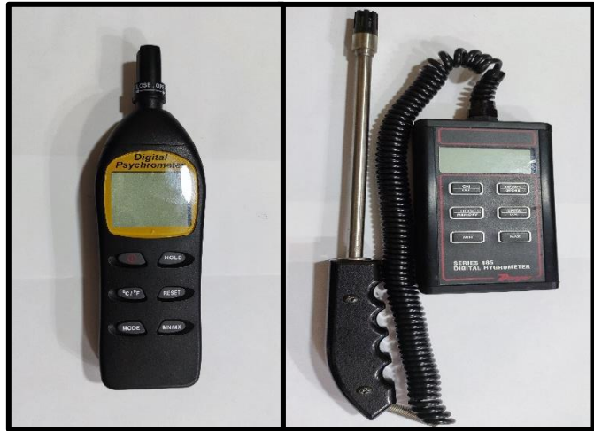
Figura 23 Higrómetros. Podemos apreciar el higrómetro OMEGA del lado izquierdo y el higrómetro DWYER del lado derecho.
