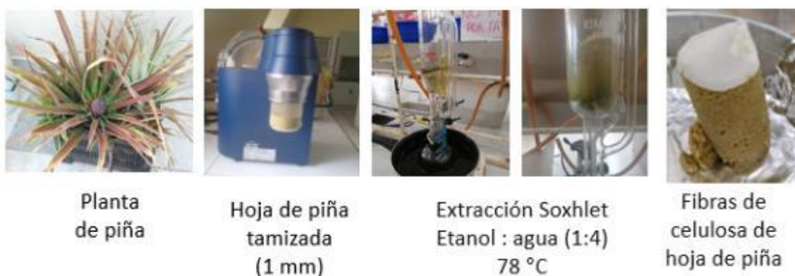
Figura 11. Proceso de extracción Soxhlet.
