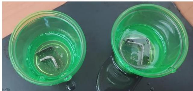
*Figura 61: Vaciado de resina epoxi.*
