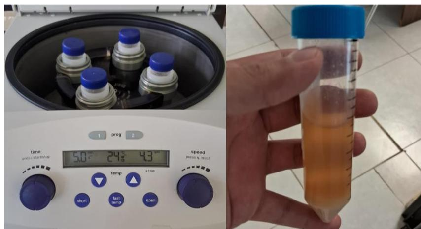
**Figura 15.** Centrifugación de los tubos Falcon.
