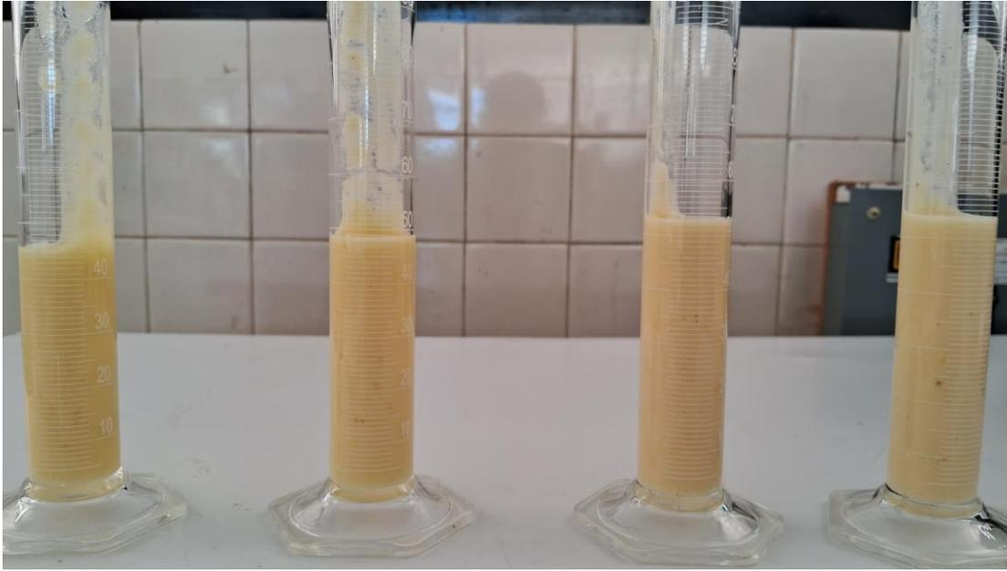
**Figura 19.** Ensayo de estabilidad de espuma montado.
