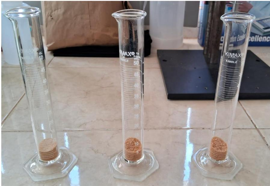
**Figura 21.** Ensayo de densidad y compactación de los polvos.
