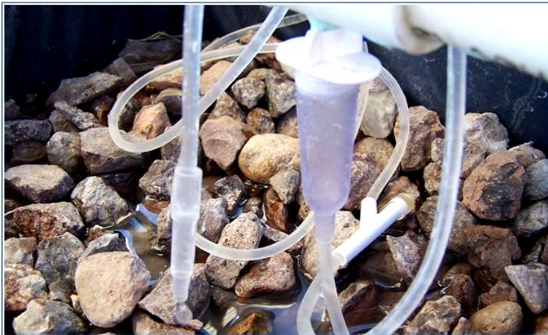
Figura V.28. Instalación del sistema de venocllisis
