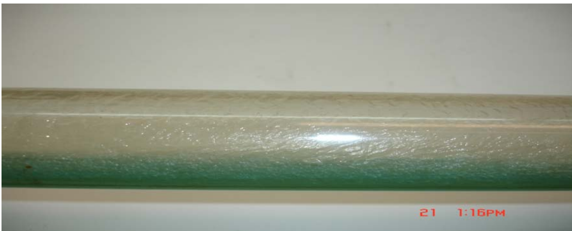
Figura 4.1 Patrón de flujo anular con R_g = 70\% y U_{SG} = 20 m/s y R_l = 30\% y U_{SL} = 1.5 m/s
