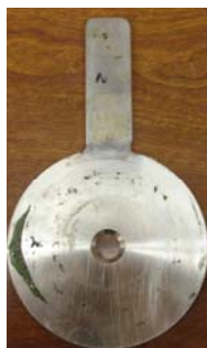
Figura A.2 Placa de orificio utilizada
