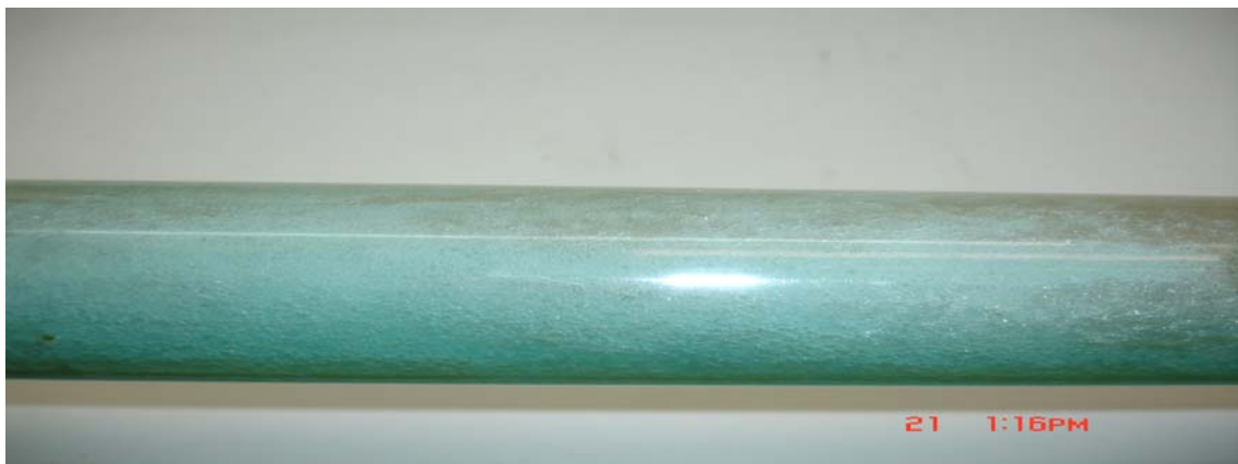
Figura 4.3 Patrón de flujo anular R_g = 90\% y U_{SG} = 25 m/s y R_l = 10\% y U_{SL} = 1.0 m/s
