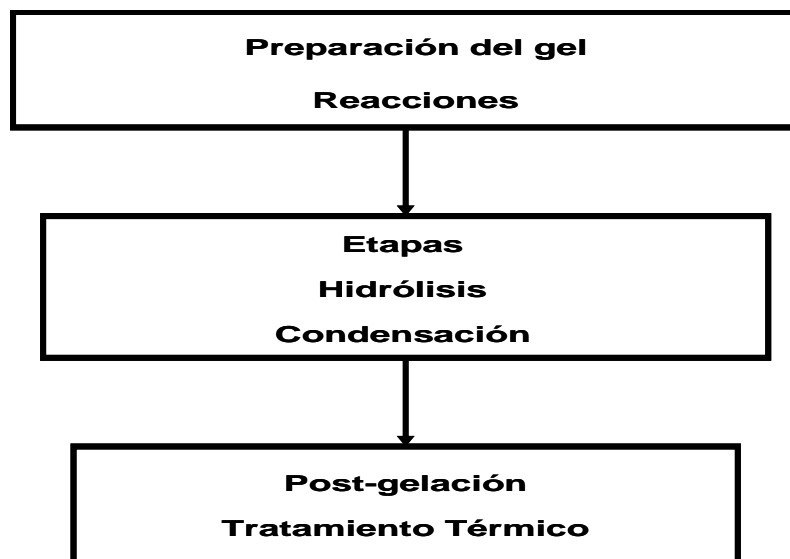
Figura 3 Preparación del TiO 2 mediante el proceso sol-gel
