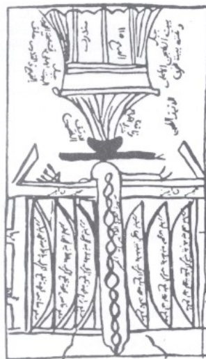
Fig. 1.2 El molino de viento Persa de eje vertical, de acuerdo a al-Dimashqi (1300 D.C)
