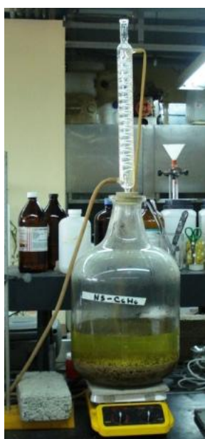
Figura 14 Equipo de reflujo para la obtención del extracto de cloroformo de bulbo de P. michuacana
