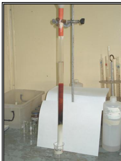
Figura 16 Esquema de la cromatografía de columna CC
