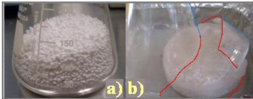
Figura 3.5 Cloruro de calcio antes a) y después b) del experimento de saturación con agua. Se puede apreciar que en a) el material es granuloso, y en b) el material forma un bloque sólido que al aumentar de volumen rompió el matraz (ver contornos de color azul y rojo).
