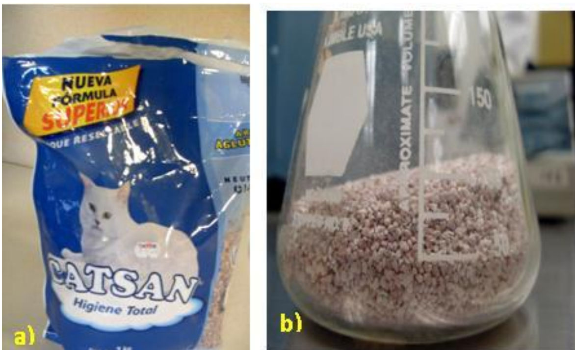
Figura 2.7 Zeolita “G”. a) Empaque de la arena para gatos. b) Presentación de la zeolita G
