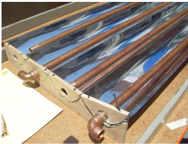
Figura 3.18 CPC [UACM 2009], para uso de calentamiento domestico de agua.
