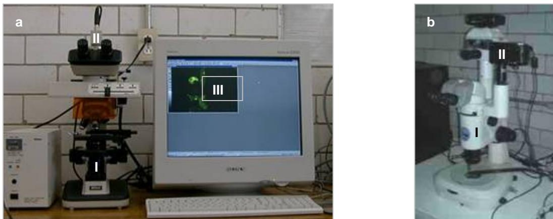
Figura 5.3 Equipo de análisis de imágenes. a) Microscopio óptico b) Estereoscopio
