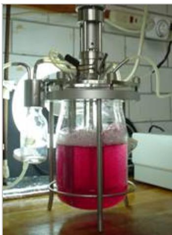
Figura 5.2 Biorreactor de 2 l usado para el cultivo de *B. vulgaris*
