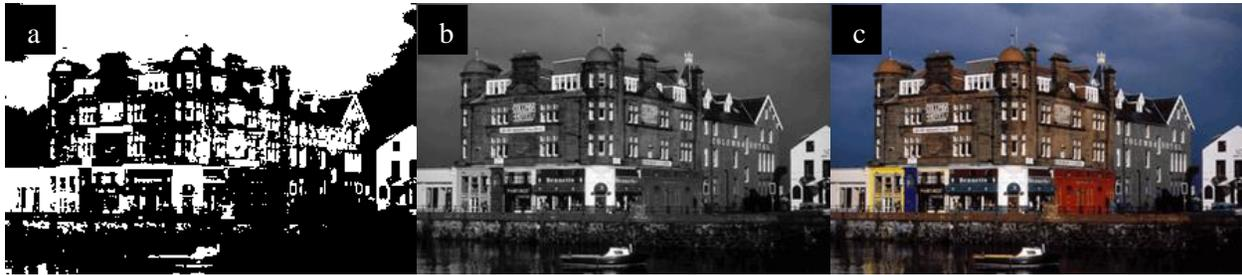
Figura 10. Imagen a tres profundidades de color. a) Imagen en blanco y negro o de 1 bit, b) Imagen en escala de grises o de 8 bits, c) Imagen a colores o de 24 bits
