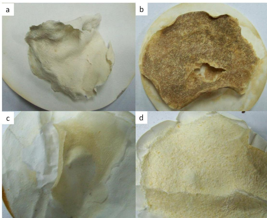
Figura 68. Pulpas blanqueadas para RACT y RACL a 90% de  $\text{CH}_3\text{COOH}$  y 1.5% de  $\text{HCl}$ . (a) y (c) RACL; (b) y (d) RACT
